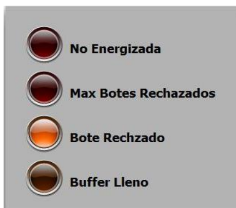
Figura 89. Visualización de las Alarmas en la estación de Medición
