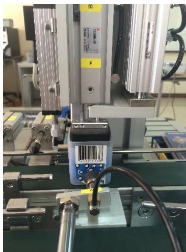
Figura 5. Medición de altura de las perlas contenidas en los recipientes
