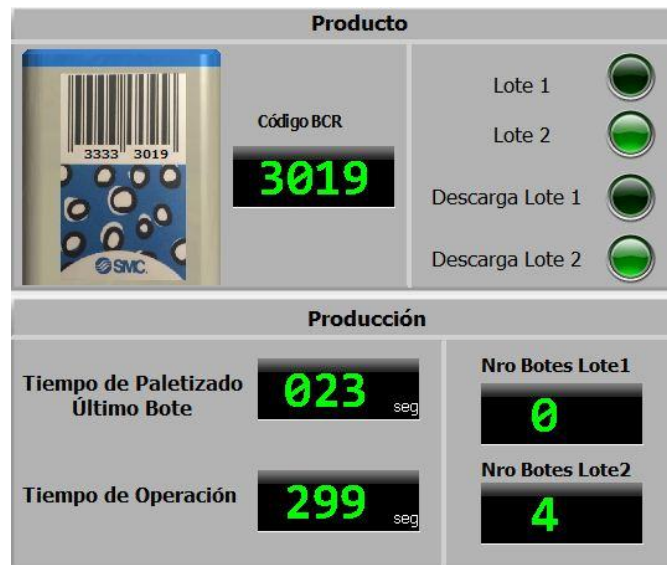
Figura 99. Variables relevantes de la estación de paletizado
