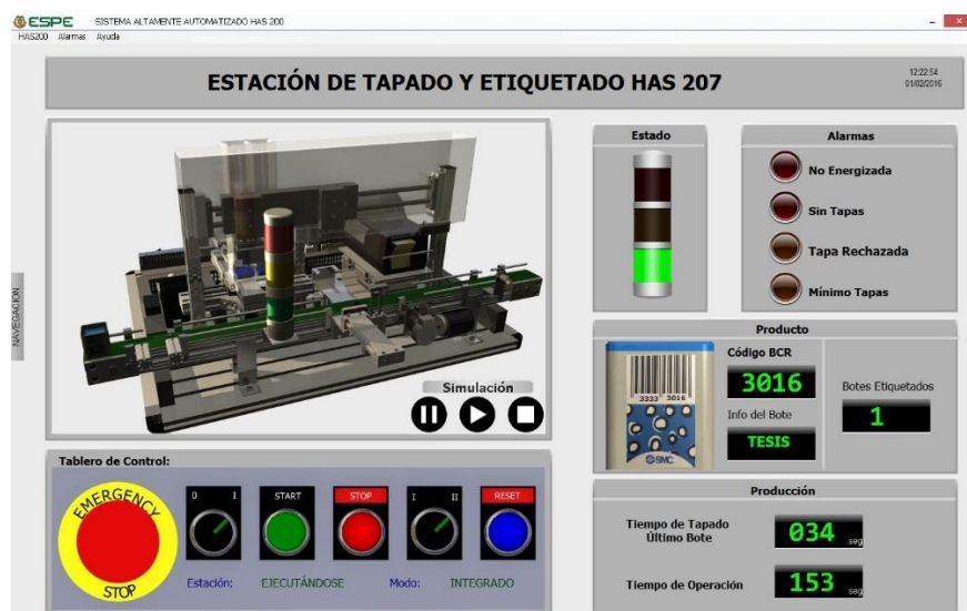
Figura 97. HMI implementado para la estación de Tapado
