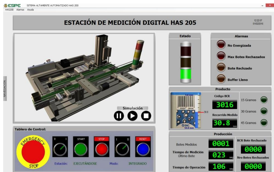
Figura 93. HMI implementado para la estación de Medición
