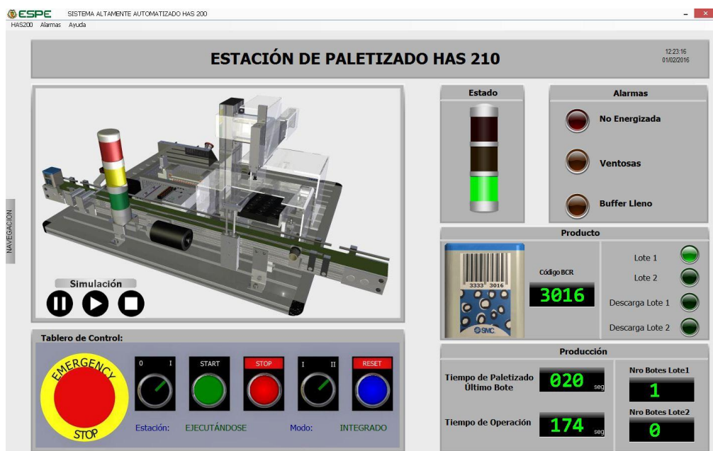
Figura 101. HMI implementado para la estación de Paletizado
