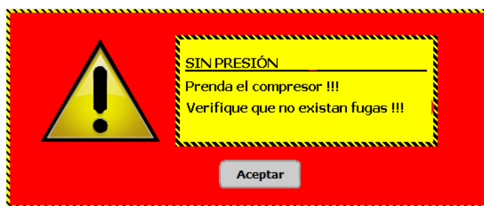
Figura 77. Representación de Alarma critica
