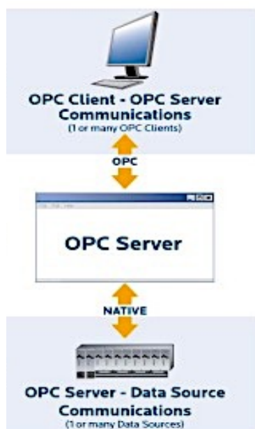
Figura 19. Estructura básica de un OPC Server
