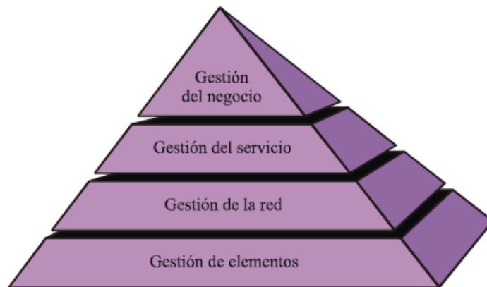
Figura 5. Arquitectura lógica por capas de RGT
