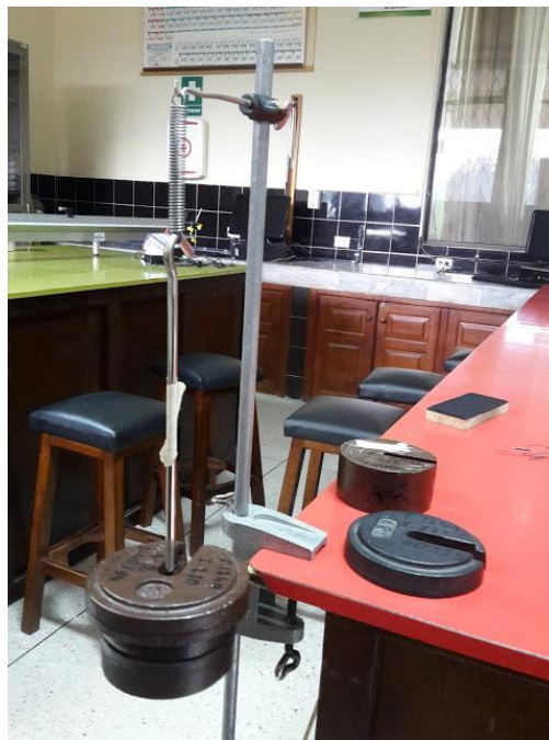
Figura 95. Pruebas de laboratorio para hallar la constante K del resorte
