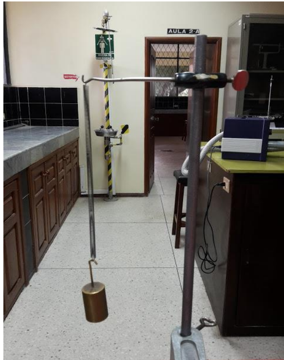
Figura 97. Pruebas de laboratorio para hallar la constante K del resorte
