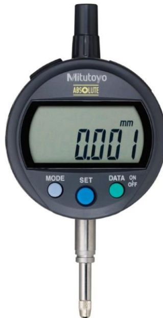
Figura 124. Comparador digital escogido para calibración del verificador de comparadores
