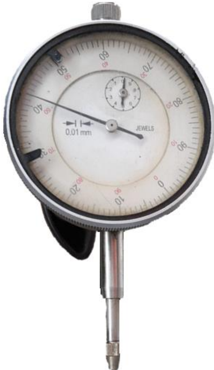
Figura 11. Lectura en un comparador de reloj
