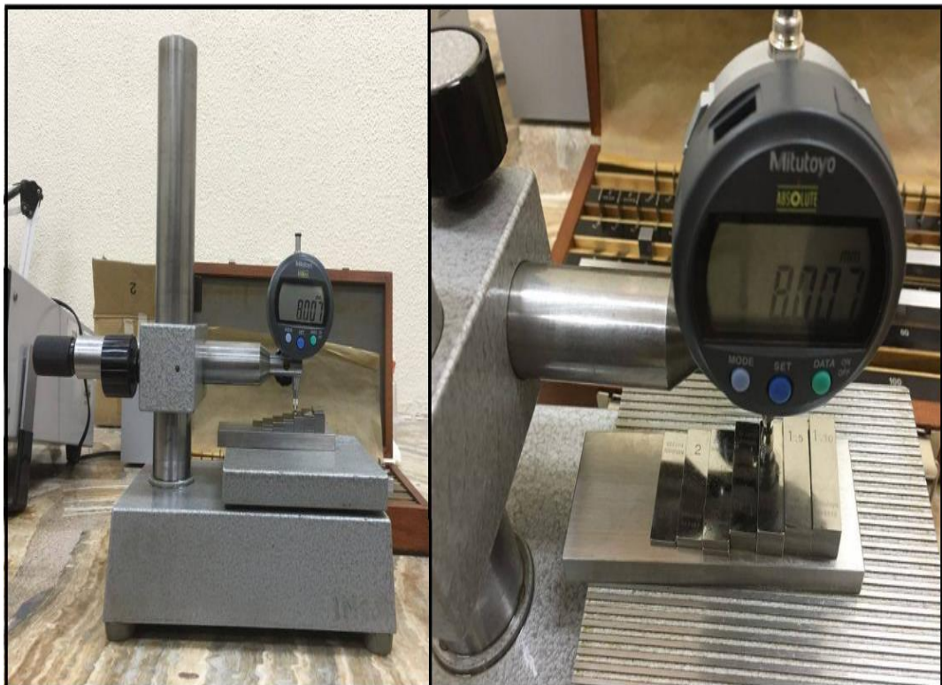
Figura 126. Instalación para comparar variaciones de medidas entre el comparador digital y los patrones de caras paralelas
