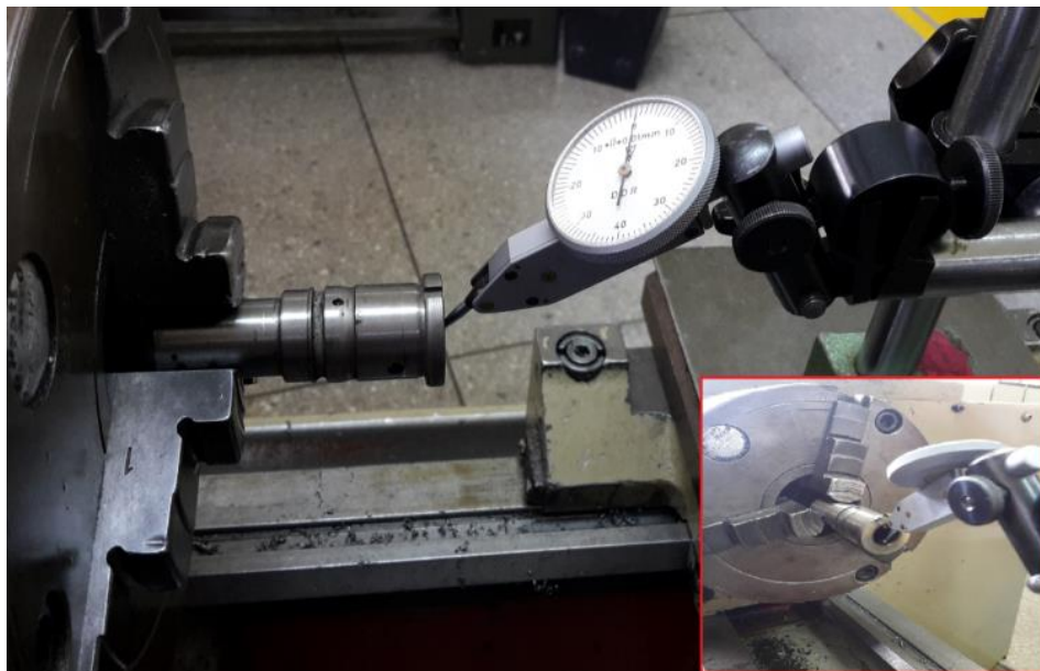
Figura 24. Verificación de la circularidad interior de un cilindro de una bomba de inyección a diesel
