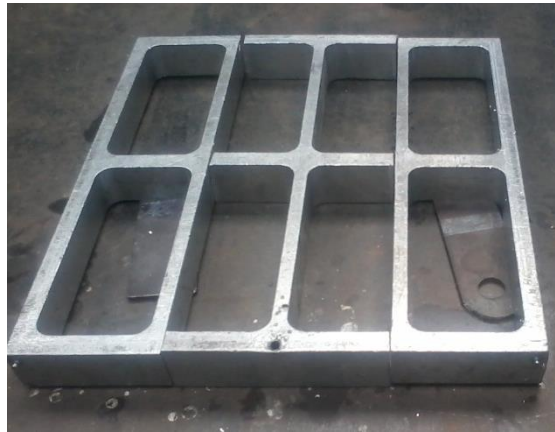
Figura 48. Aluminio reusado para fabricación de carcasa
