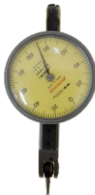
Figura 20. Reloj comparador universal o angular
