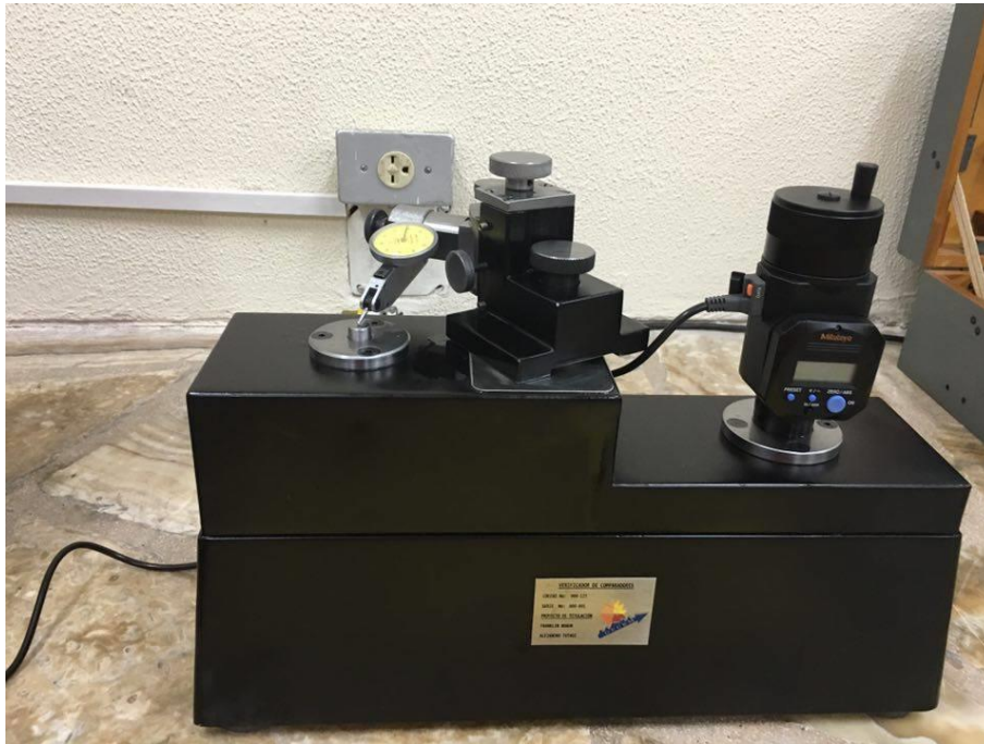
Figura 140. Montaje para la toma de datos en la verificación de un comparador universal Peacock
