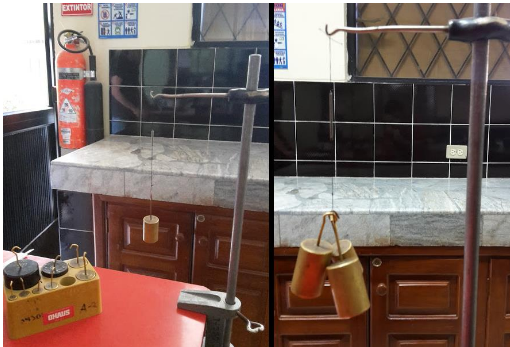
Figura 75. Pruebas de laboratorio para hallar la constante de elasticidad del resorte
