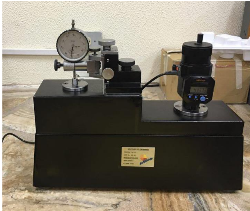
Figura 143. Montaje para la toma de datos en la verificación de un comparador de reloj analógico Steinmeyer
