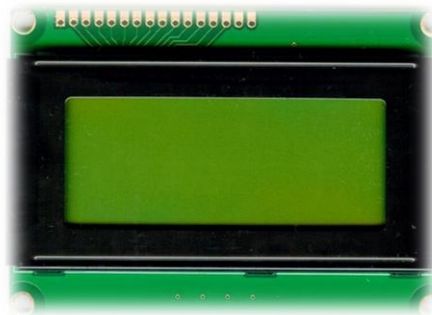
Figura 8 Figura real de una pantalla LCD 16x4
