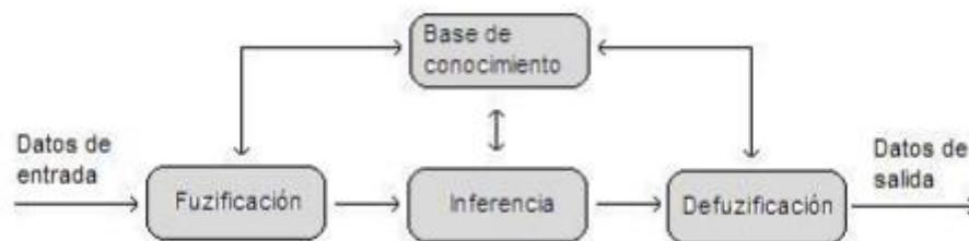
Figura 39 Estructura de un controlador difuso
