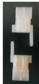
Figura 103 Conector antiguo del motor de la columna
