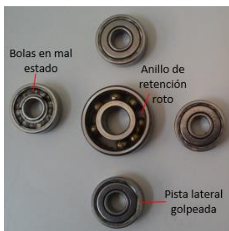
Figura 110 Rodamientos en mal estado retirados de la columna
