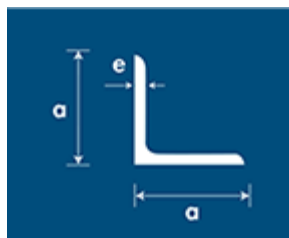
Figura 105 Ángulos estructurales en L, donde a=20\text{mm} , e=2\text{mm} .
