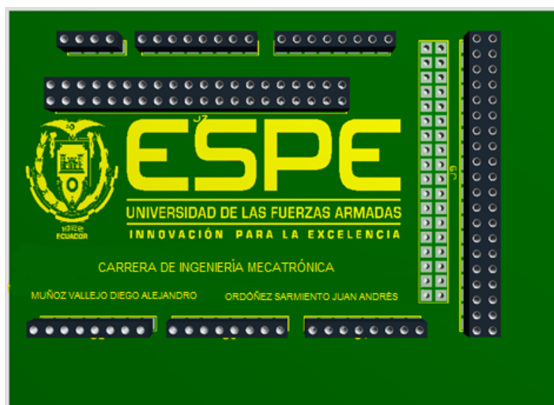
Figura 88 Placa de comunicación Arduino – Placa de control
