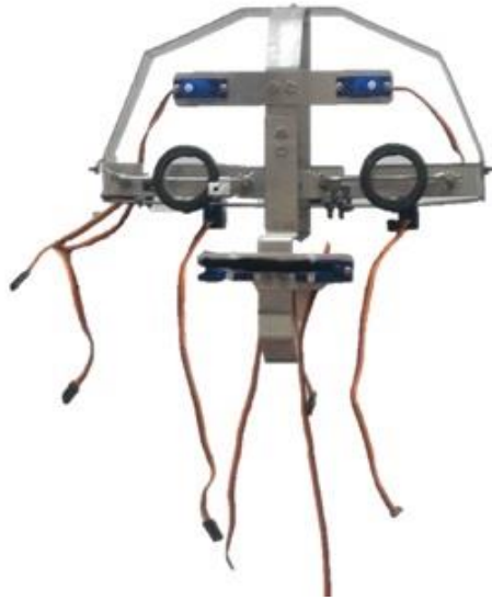
Figura 100 Ensamblaje de ojos, cejas y boca
