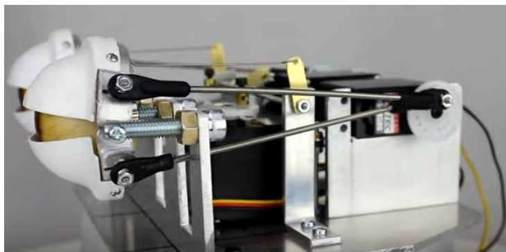
Figura 38 Mecanismo de ojos animatrónicos de Marshall Tearle
