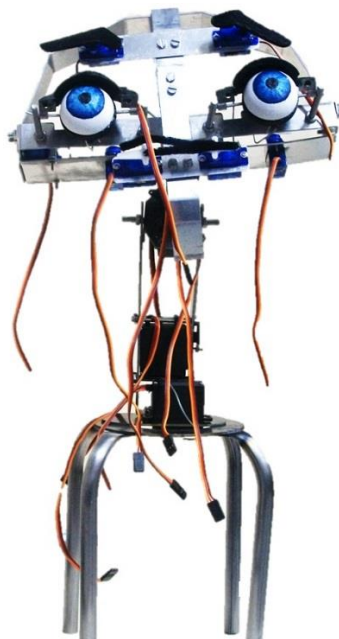
Figura 103 Ensamble estructura interna (cuello y cabeza)
