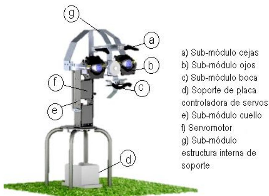
Figura 94 Etapa física interna de Cody
