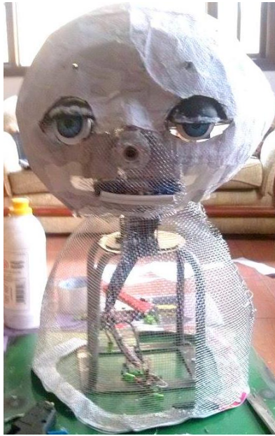
Figura 106 Cuerpo en base a mallas metálicas y cabeza de cartón
