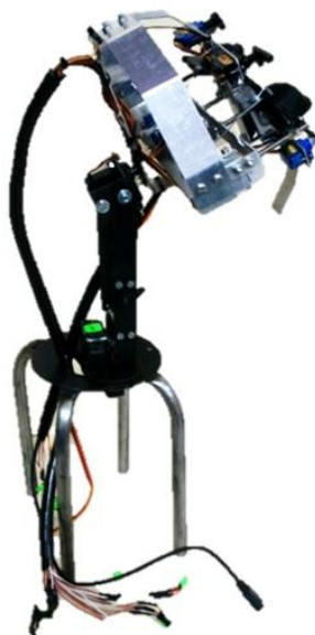
Figura 104 Estructura interna con cables de servo-motores etiquetados y organizados
