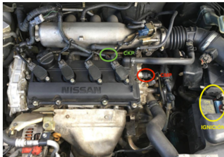
Figura 35 Ubicación CKP, CMP e Ignición
