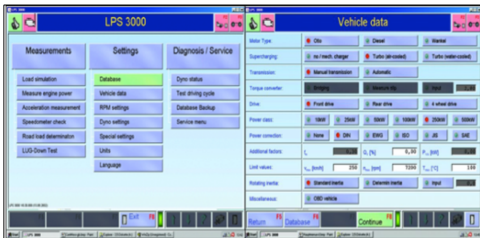
Figura 31 Interface del dinamómetro MAHA LPS 3000 Fuente: (Maha Maschinenbau Haldenwang, 2011)
