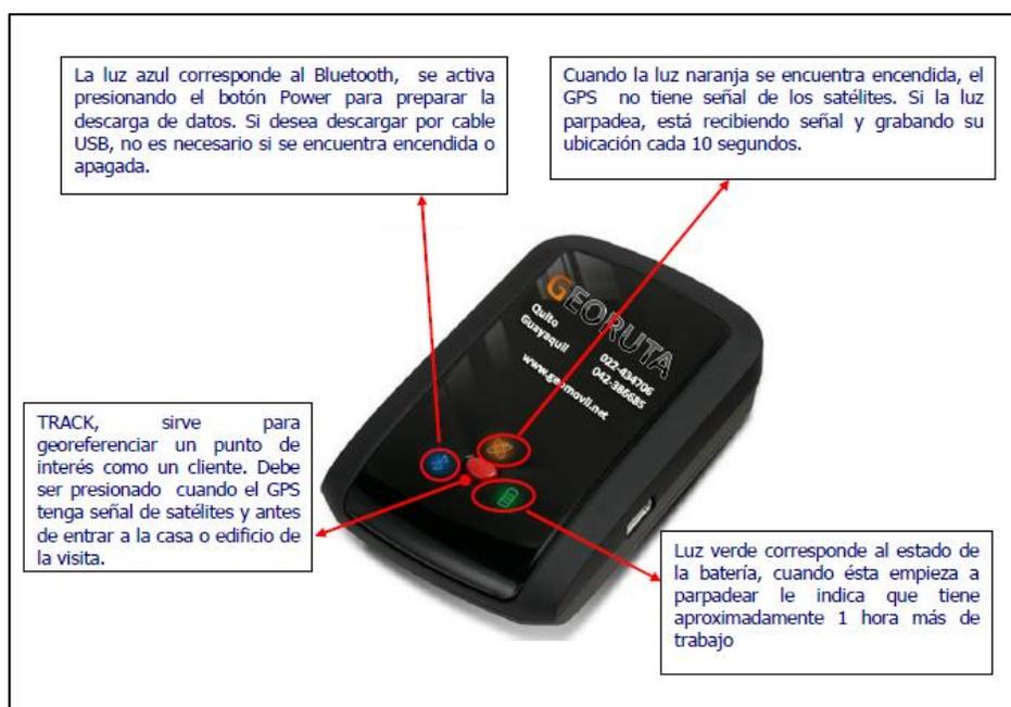
**Figura 1 Imagen del Equipo de rastreo satelital GEORUTA GPS**
