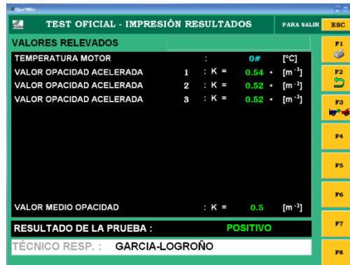
Figura 31 Valores de opacidad medidos en una prueba
