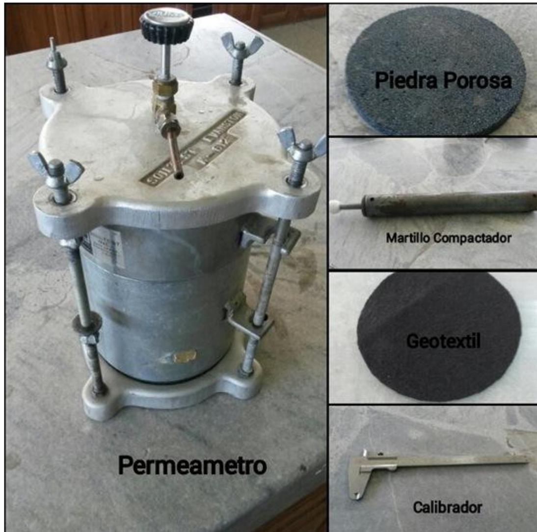
Figura 27 Equipo permeabilidad carga constante
