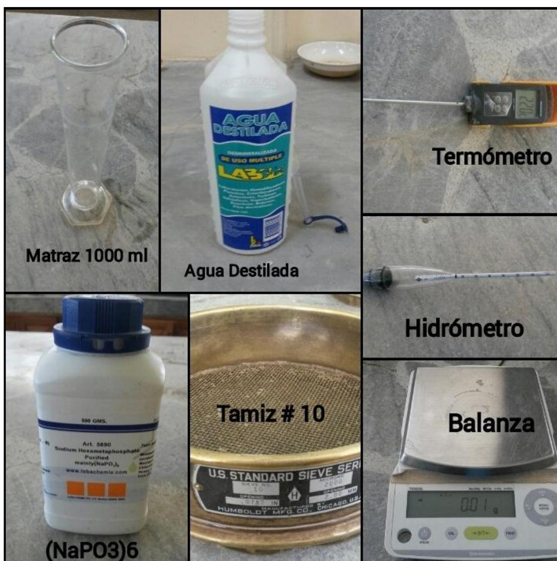
Figura 14: Equipo granulometria por Sedimentación
