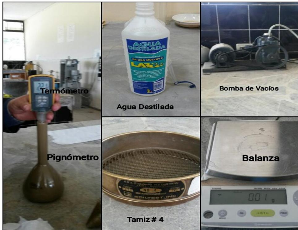
**Figura 19:** Equipo Ensayo Gravedad Especifica
