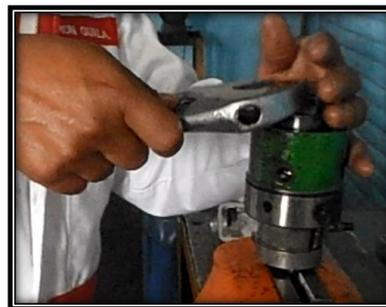
**Figura No. 74. Desmontaje del perno excéntrico**
