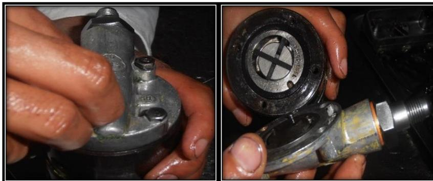
**Figura No. 71. Desmontaje de la bomba de transferencia**
