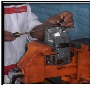
**Figura No. 81. Montaje del retén del buje de transmisión**
