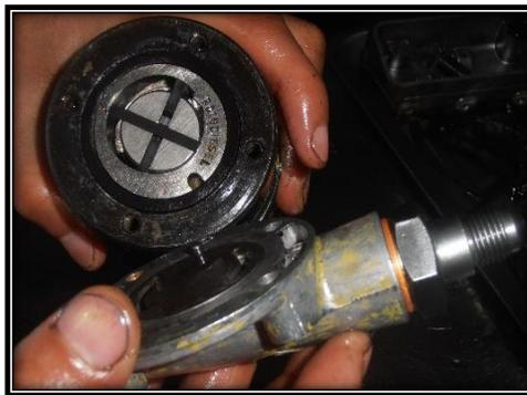
**Figura No. 92. Ubicación de la bomba de transferencia en el cabezal hidráulico**
