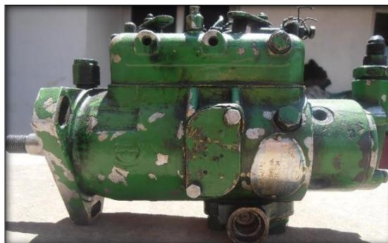
**Figura No. 62. Bombas de inyección CAV de tipo DPA**
