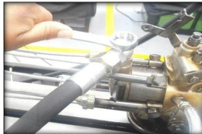
**Figura No. 140. Ajuste de la bomba de transferencia**
