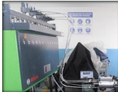
**Figura No. 108. Instalación de las cañerías de alta presión**
