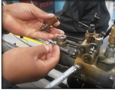
**Figura No. 138. Desarmado de la bomba de transferencia**
