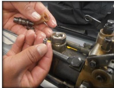
**Figura No. 144. Desarmado de la bomba de presión**
