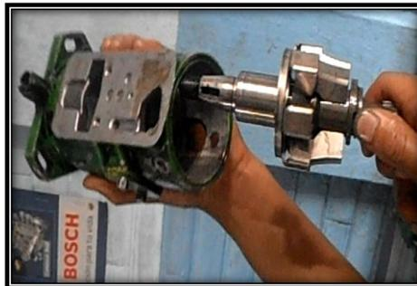
**Figura No. 79. Desmontaje del eje de accionamiento**
