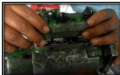
**Figura No. 65. Desmontaje de la tapa superior**
