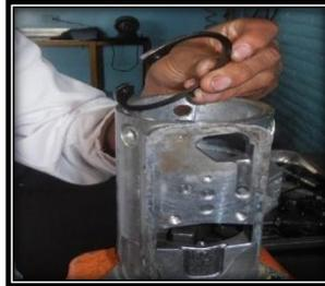
**Figura No. 83. Ubicación del anillo de sincronización**
