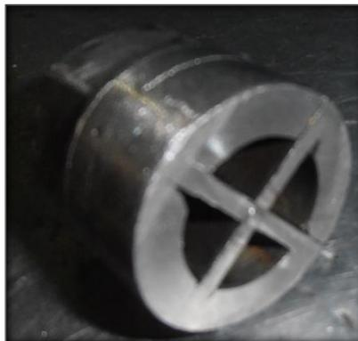
**Figura No. 58. Extractores del rotor de alimentación**
