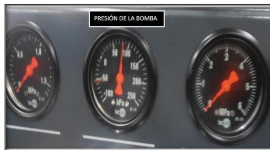
**Figura No. 147. Manómetro indicador de la presión a 800 rpm**
