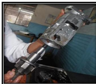
**Figura No. 82. Montaje del eje impulsor con sus elementos**
