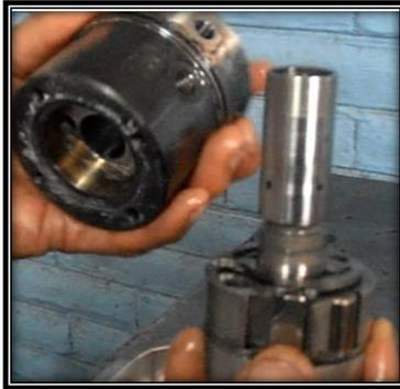
**Figura No. 88. Montaje del cabezal y sus elementos**
