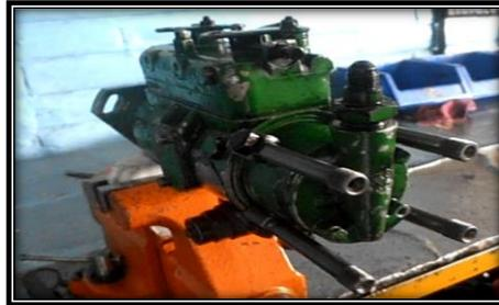
**Figura No. 63. Bomba de inyección CAV de tipo DPA montado en el dispositivo**
