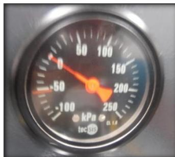
**Figura No. 137. Manómetro que verifica la presión de la bomba**
