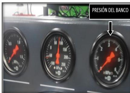
**Figura No. 130. Presión del banco de pruebas Bosch EPS 815**
