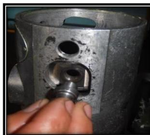
**Figura No. 85. Ubicación del tornillo del avance de la leva**
