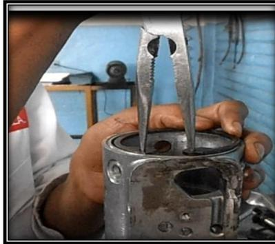
**Figura No. 78. Desmontaje del anillo de sincronización**
