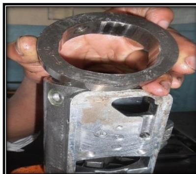
**Figura No. 77. Desmontaje del anillo de levas**
