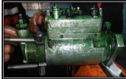
**Figura No. 64. Pernos de salida de combustible en la bomba de inyección**
