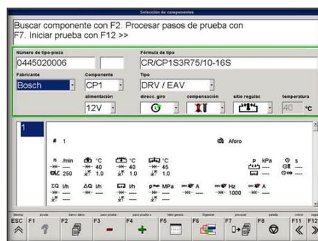
**Figura No. 122. Datos ingresados de la bomba de inyección**
