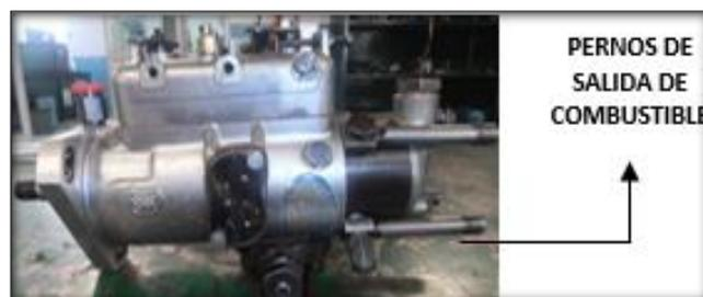
**Figura No. 16. Pernos de salida de combustible de la cabeza de la bomba rotativa CAV de tipo DPA**
