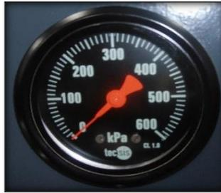
**Figura No. 143. Manómetro para medir la presión**
