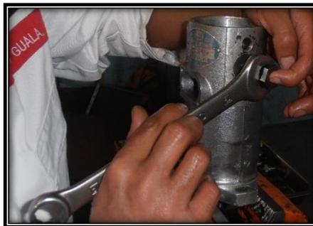
**Figura No. 76. Desmontaje del perno que soporta al anillo de levas**
