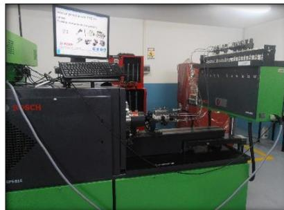
**Figura No. 109. Bomba de inyección el banco de pruebas**
