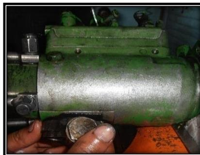
**Figura No. 95. Ensamble del dispositivo de avance**
