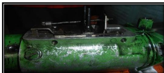
**Figura No. 96. Armado del mecanismo de control del gobernador**
