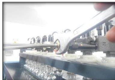
**Figura No. 135. Pernos de verificación, pasó de combustible a los inyectores**
