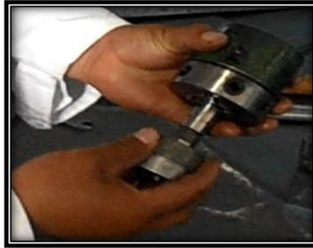
**Figura No. 75. Desmontaje de los elementos del cabezal hidráulico**
