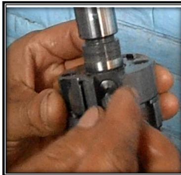
**Figura No. 86. Montaje de los émbolos de bombeo o elementos de bombeo**
