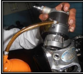
**Figura No. 93. Montaje del cabezal hidráulico dentro del alojamiento de la bomba**
