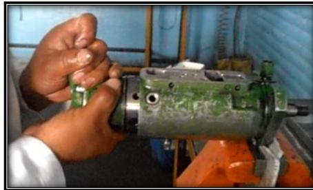
**Figura No. 70. Desmontaje del cabezal hidráulico**
