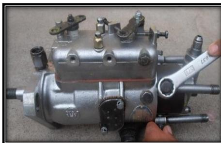
**Figura No. 99. Ajuste de los pernos de salida de combustible**
