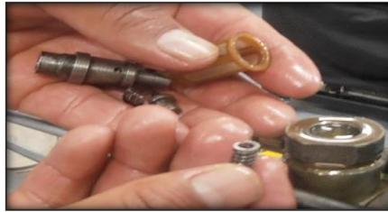
**Figura No. 72. Despiece de la bomba de transferencia**
