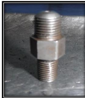
**Figura No. 60. Dispositivo de acople para medir la presión de la bomba de inyección**
