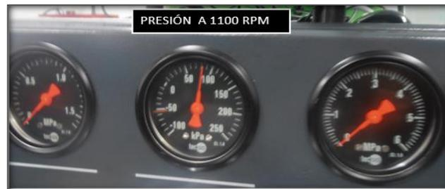
**Figura No. 170. Presión de transferencia a 1100 rpm**
