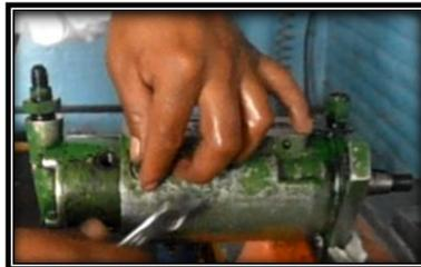
**Figura No. 94. Ajuste de los pernos para asegurar el cabezal hidráulico**
