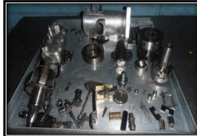
**Figura No. 80. Bomba de inyección desmontada en su totalidad**
