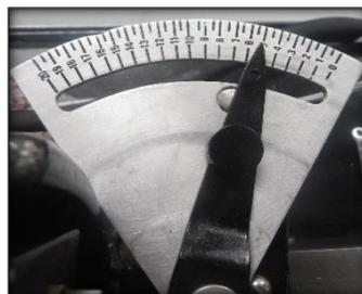
**Figura No. 158. Valor de calibración a 1450 rpm**
