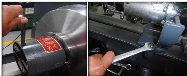
**Figura No. 106. Ajuste de los pernos que aseguran la bomba de inyección en el bnco de pruebas**
