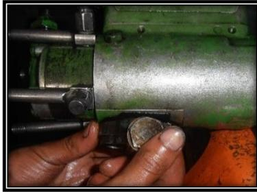
**Figura No. 69. Desmontaje del dispositivo de avance**
