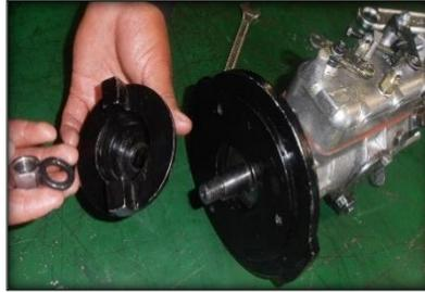
**Figura No. 104. Ubicación del acople cónico en la bomba de inyección**
