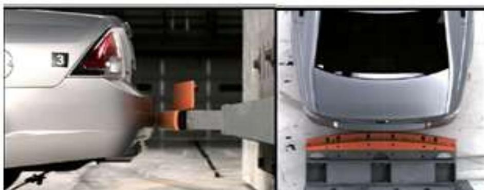
**Figura 33 Test parachoque posterior.**
