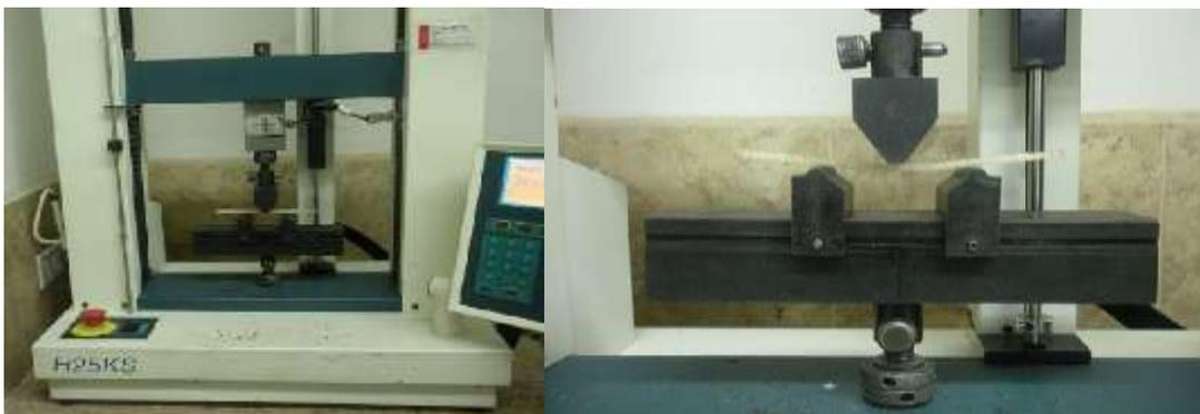
**Figura 60** Ensayos de flexión realizados en las probetas de material compuesto, siguiendo los parámetros de la norma ASTM D7264-15.
