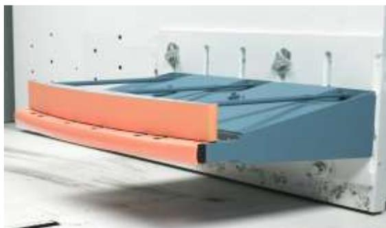
**Figura 34 Barrera de parachoques de acero con anti - retorno.**
