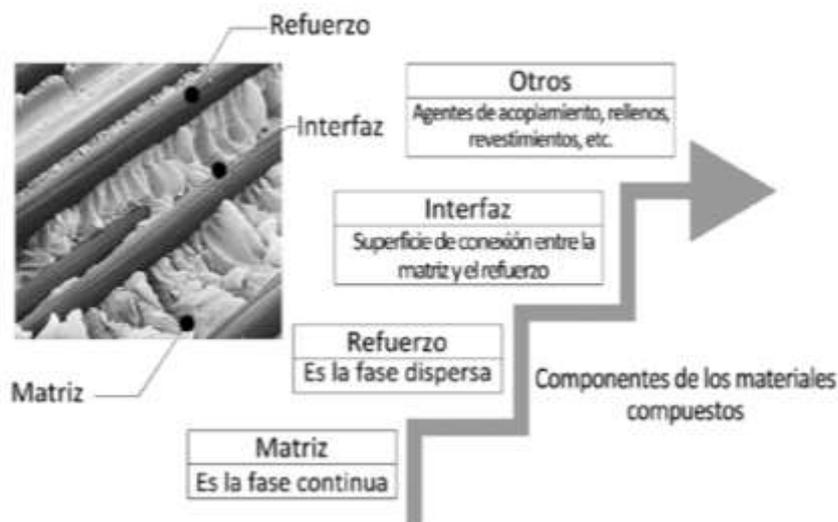
**Figura 4 Componentes los materiales compuestos.**
