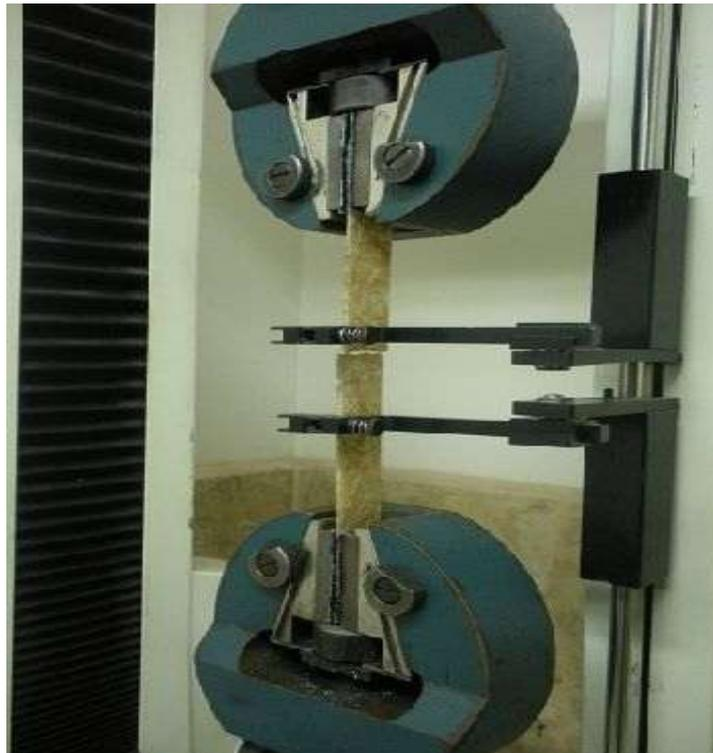
**Figura 47** Ensayo de tracción siguiendo los parámetros de la norma ASTM D 3039-08.
