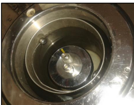
Figura 46 Instalación de bomba en el calorímetro
