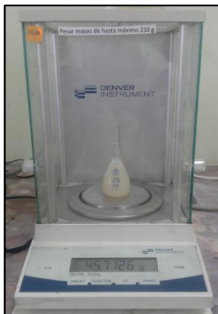
Figura 37 Masa de combustible emulsionado
