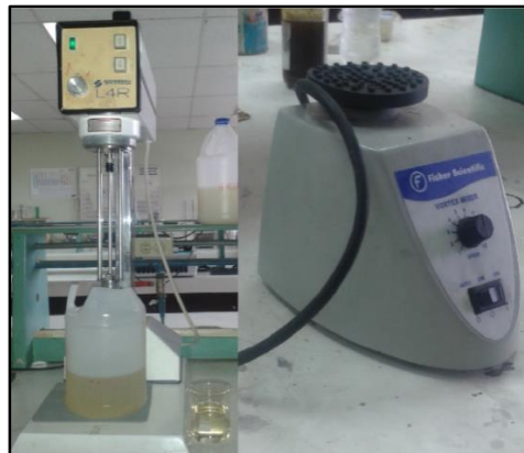
Figura 25 Mezcladores para elaboración de emulsiones
