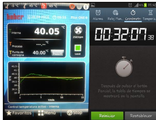
Figura 35 Interface de baño térmico Huber y cronómetro
