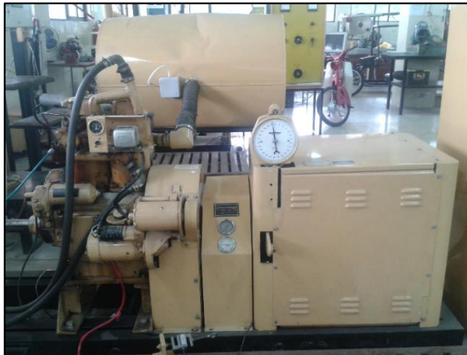
Figura 49 Banco motor PLINT TE-16
