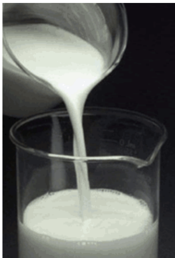
Figura 8 Apariencia blanca por dispersión de luz generada por el agua Fuente: (Alternative petroleum technologies [APT], 2013)
