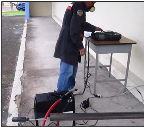
Figura 52 Toma de datos de gases de combustión
