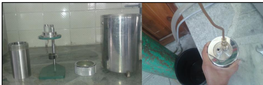
Figura 45 Elementos de la bomba y llenado de oxígeno
