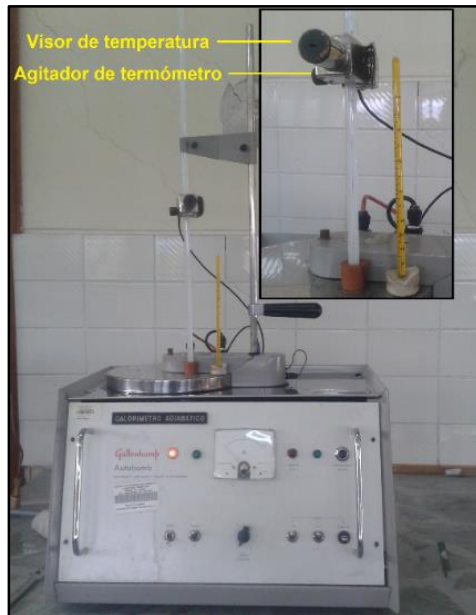
Figura 47 Lectura de temperatura en la bomba calorimétrica
