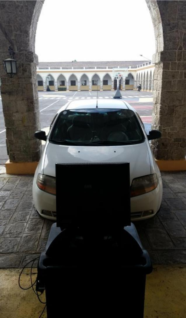
El equipo de medición, es un analizador de gases CARTEK modelo 50-100, calibrado para condiciones de ralentí (500-1100 rpm) y velocidad crucero (2000-2750 rpm)
