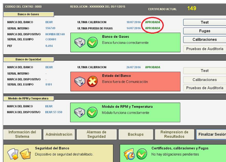
Figura 62 Certificados de calibración y fugas aprobados
