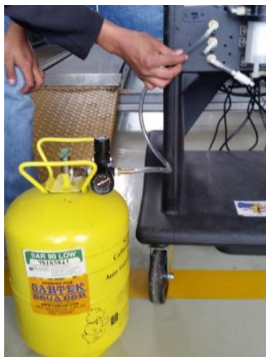
Figura 58 Conexión al puerto de calibración
