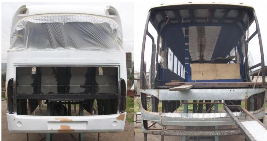
**Figura 20** Aplicación de la fibra de vidrio en la carrocería
