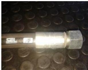
Seleccione dos mangueras hidráulicas de longitud 1000 mm y 1100 mm, SAE100 R1AT8 1/2" WP160BAR/ 2320 PSI.
