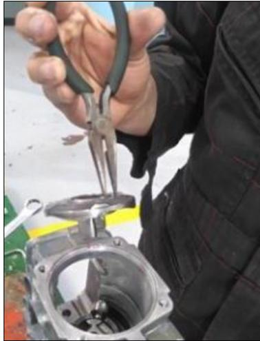
**Figura 91 Montaje del disco de levas.**
