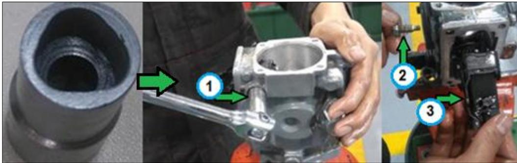
**Figura 66 Extracción palanca del regulador**
