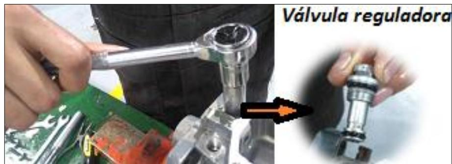
**Figura 89 Montaje de la válvula reguladora**
