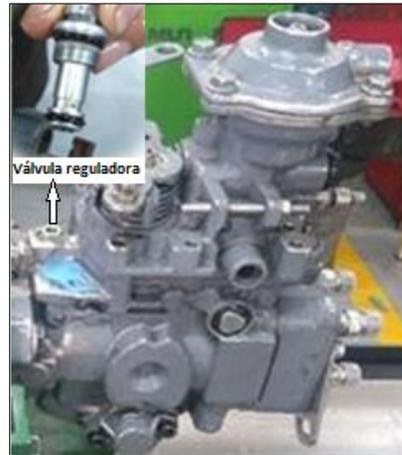
**Figura 20 Válvula reguladora de presión**
