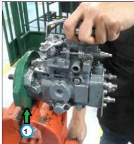
**Figura 55 Montaje de la bomba en el dispositivo de sujeción**
