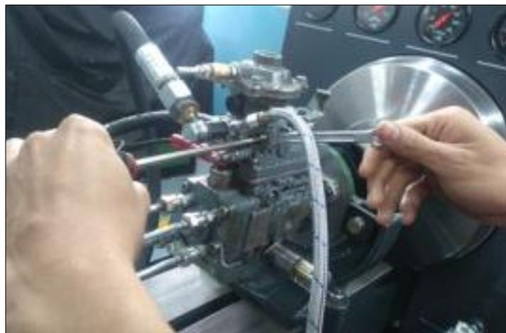
Figura 129 Tornillo de regulación de ralentí
