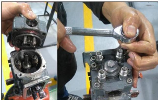
**Figura 94 Montaje del cabezal**
