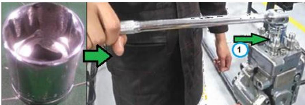
**Figura 61 Extracción del tapón de cabeza de distribución**
