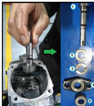
**Figura 65 Extracción del émbolo distribuidor**
