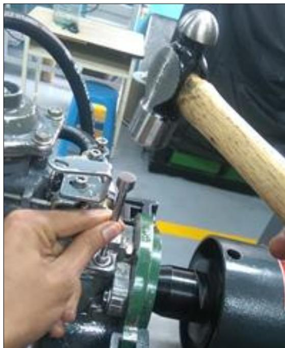
**Figura 126 Regulación de la presión de la bomba**
