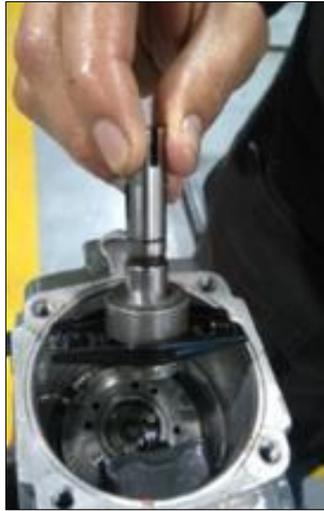
**Figura 93 Montaje del conjunto del émbolo**
