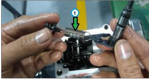
**Figura 58 Desmontaje del eje de control**
