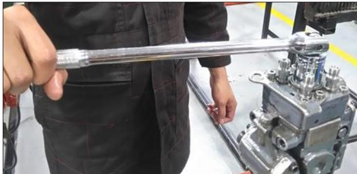
**Figura 95 Montaje del tapón del cabezal**
