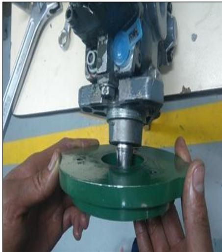
**Figura 102 Montaje de brida**
