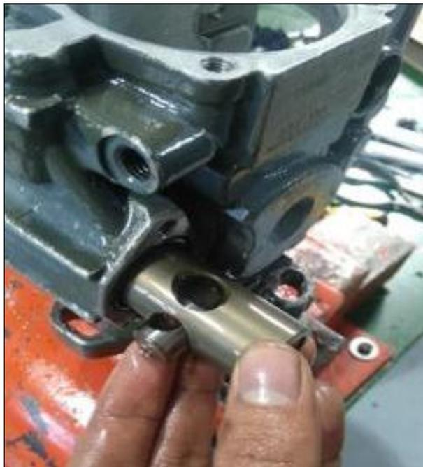
**Figura 88 Montaje del pistón de avance**
