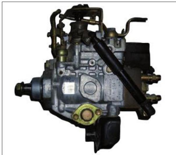
**Figura 5 Bomba rotativa de émbolo axial**
