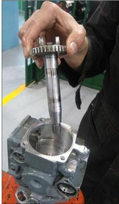
**Figura 86 Instalación del eje impulsor**
