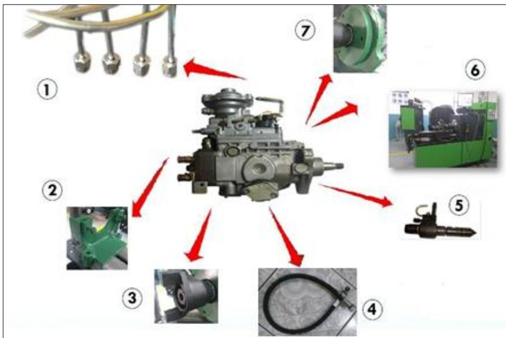
**Figura 101 Accesorios para la calibración**
