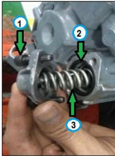
**Figura 68 Extracción del resorte del variador**
