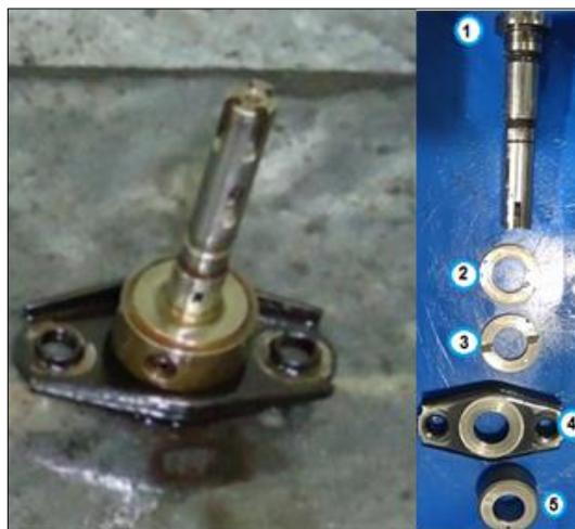
**Figura 78 Comprobación del émbolo distribuidor**
