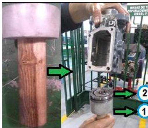
**Figura 75 Extracción bomba de alimentación**
