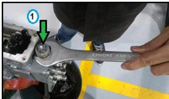
**Figura 63 Extracción del solenoide de corte de combustible**
