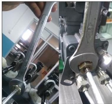
**Figura 109 Instalación de tuberías de alta presión**
