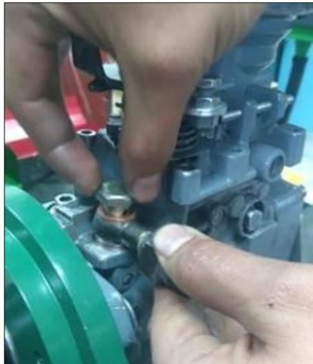
**Figura 107 Instalación mangueras flexibles y acoples**
