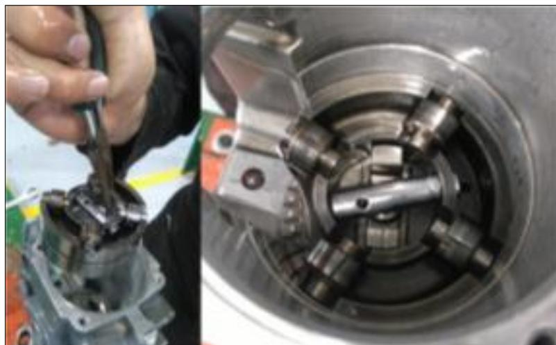
**Figura 87 Montaje del conjunto de rodillos**
