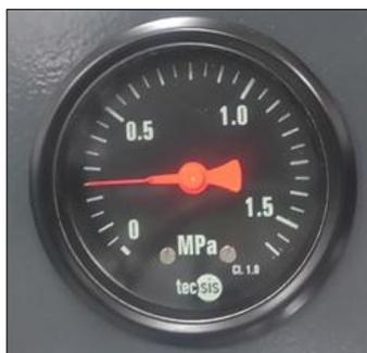
**Figura 136 Presión de bomba de alimentación**
