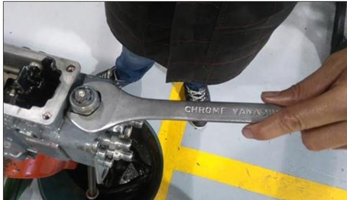
**Figura 97 Montaje del solenoide**
