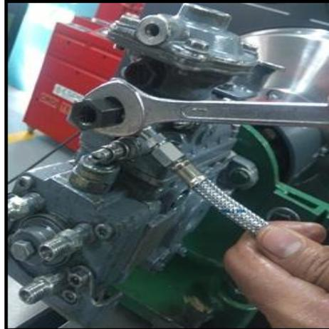
**Figura 108 Instalación de manguera de presión interna**
