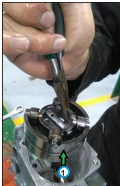
**Figura 71 Extracción del anillo de rodillo**
