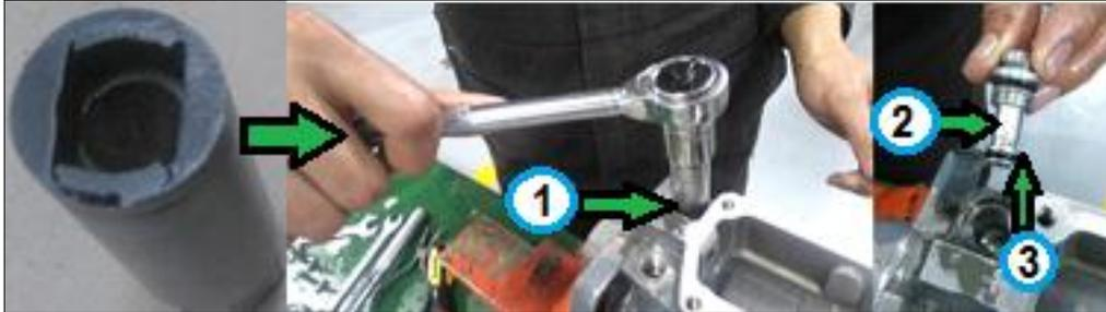
**Figura 76 Extracción de la válvula reguladora**
