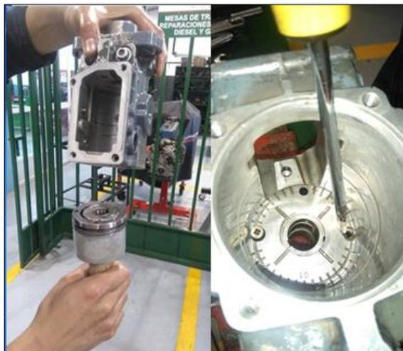
**Figura 85 Montaje de la bomba de alimentación**
