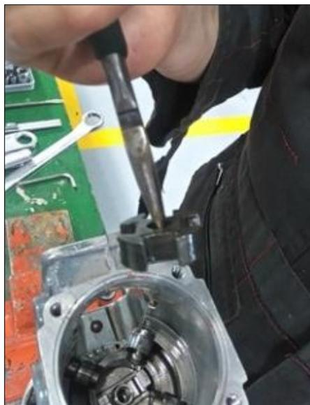
**Figura 90 Instalación del acoplador.**
