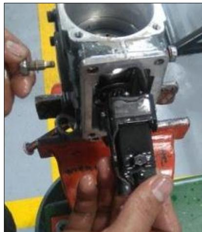
**Figura 92 Montaje de la palanca del gobernador**
