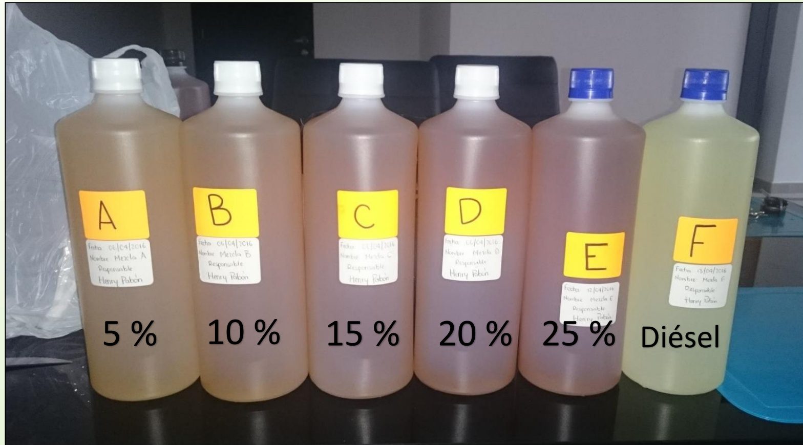
Muestras de mezclas combustibles al 5 %, 10 %, 15 %, 20 %, 25 % y diésel puro
