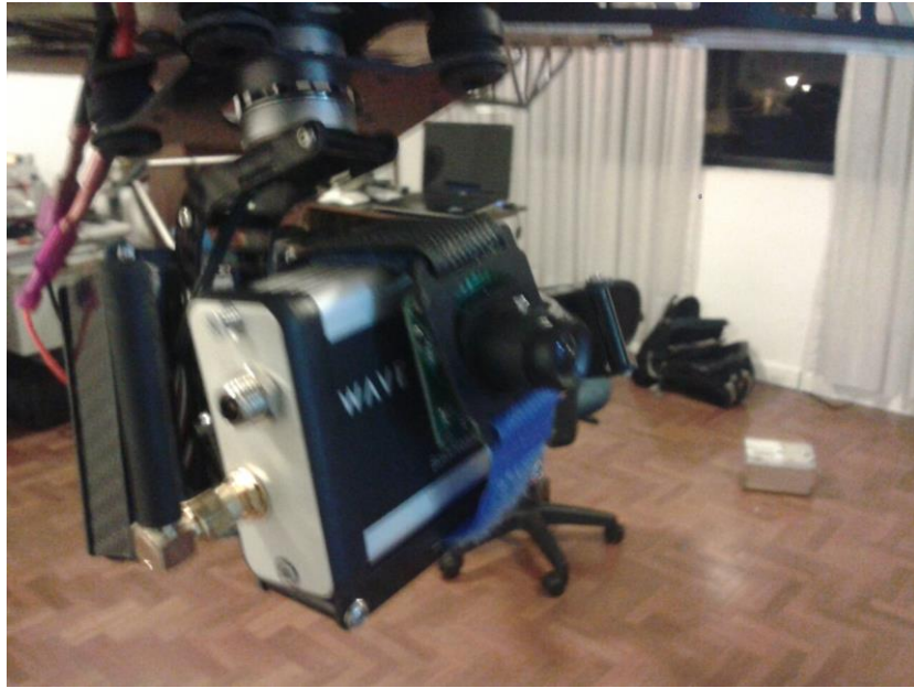
Figura 117. Soporte de cámara acoplado a la estructura
