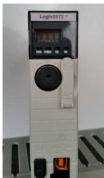
Figura 110. Procesador 1756-L72 previo a su instalación.
