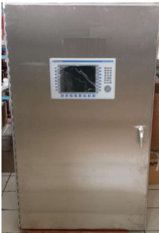
Figura 127. Vista frontal del tablero ensamblado.
