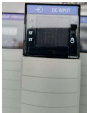
Figura 116. Módulo de entradas digitales 1756-IB16 previo a su instalación.
