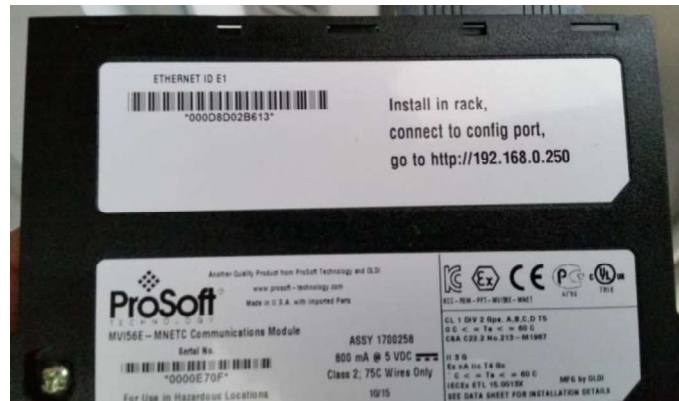
Figura 115. Datos de fábrica del módulo de comunicaciones Modbus.
