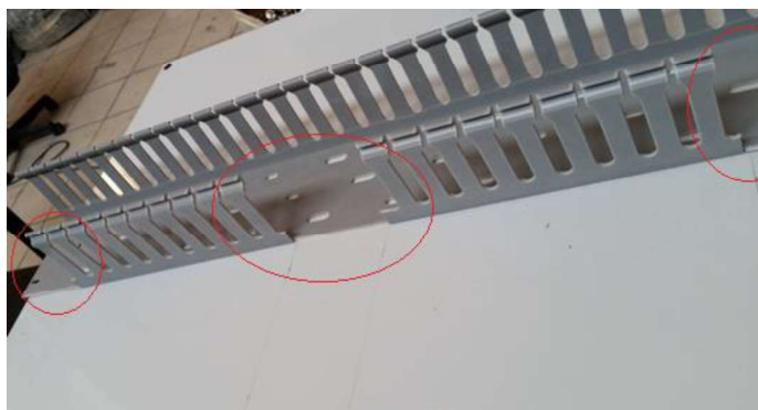
Figura 93. Cortes realizados en la canaleta.
