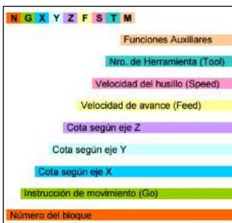
**Figura 7.** Estructura de bloque de programación.
