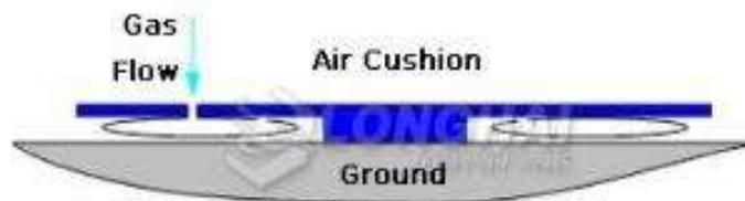
**Figura 47.** Ingreso de aire en el air bearing
