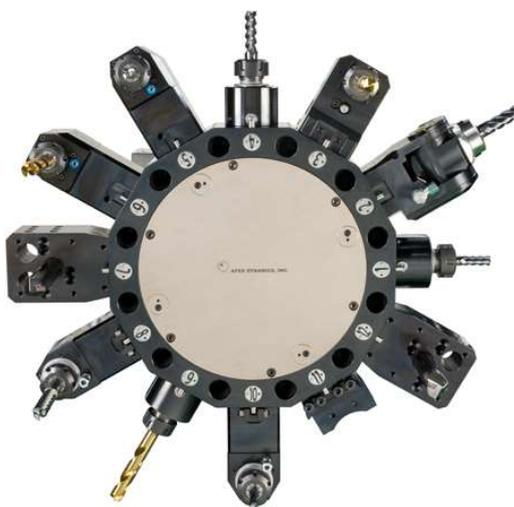
**Figura 6.** Torreta de herramientas fresadora CNC.
