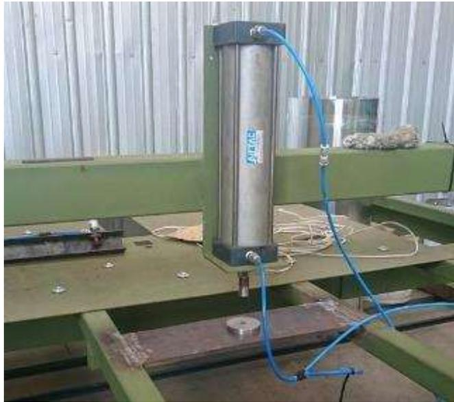
**Figura 76.** Estructura para cilindro de perforación construida físicamente
