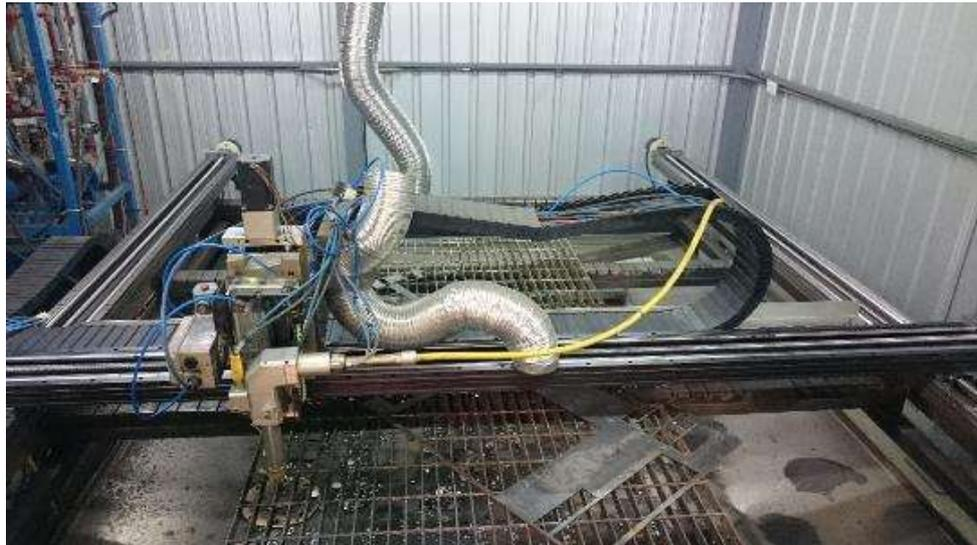
**Figura 106.** Estructura de la cortadora láser CNC
