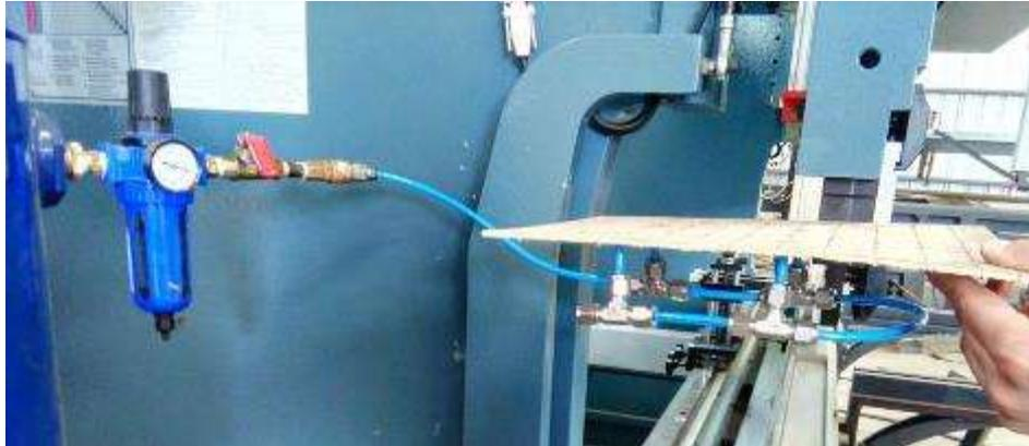
**Figura 39.** Construcción física del sistema de levitación neumática por tubería
