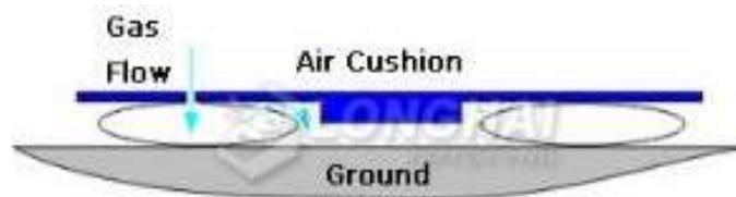
**Figura 48.** Air Bearing lleno de aire
