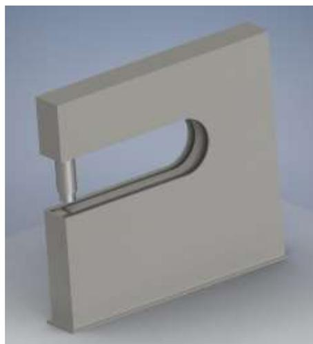
**Figura 74.** Estructura metálica para sostener cilindro de perforación
