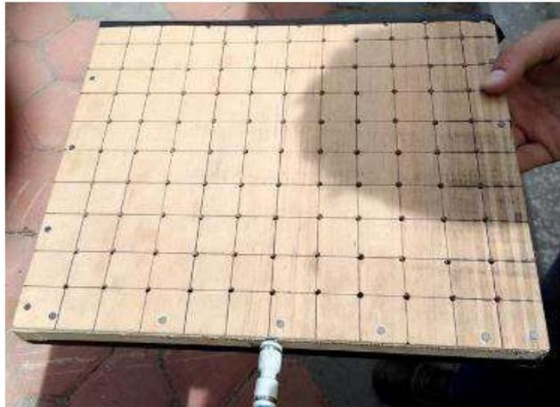
**Figura 36.** Construcción física de la cámara de aire para experimentación
