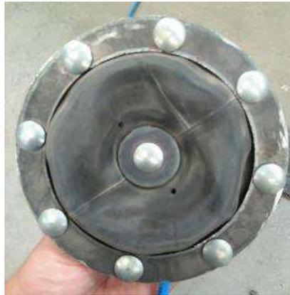
**Figura 44.** Construcción física del módulo de carga del air caster
