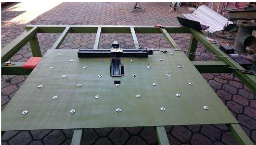
**Figura 72.** Estructura con mesa de desplazamiento y ejes de desplazamiento
