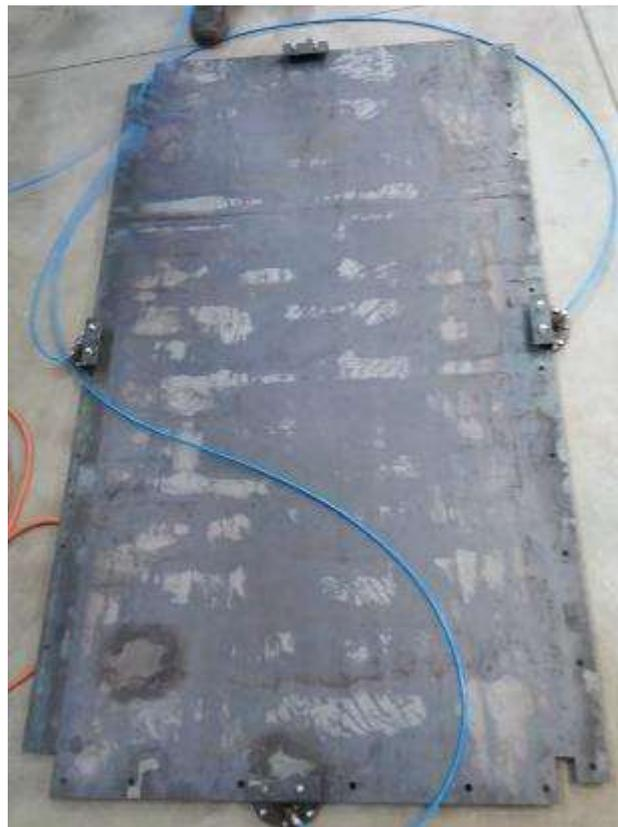
**Figura 51.** Prueba de Funcionamiento - Principio de levitación neumática por campana de aire
