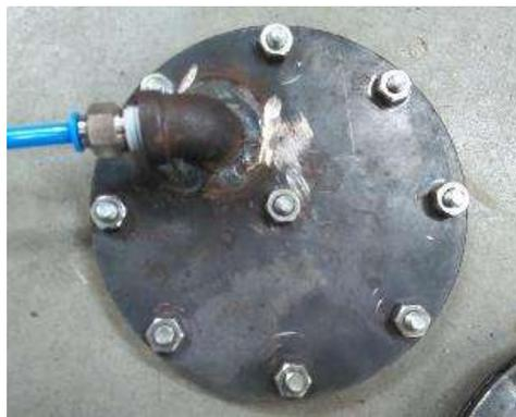
**Figura 46.** Estructura metálica con ingreso de aire del air caster
