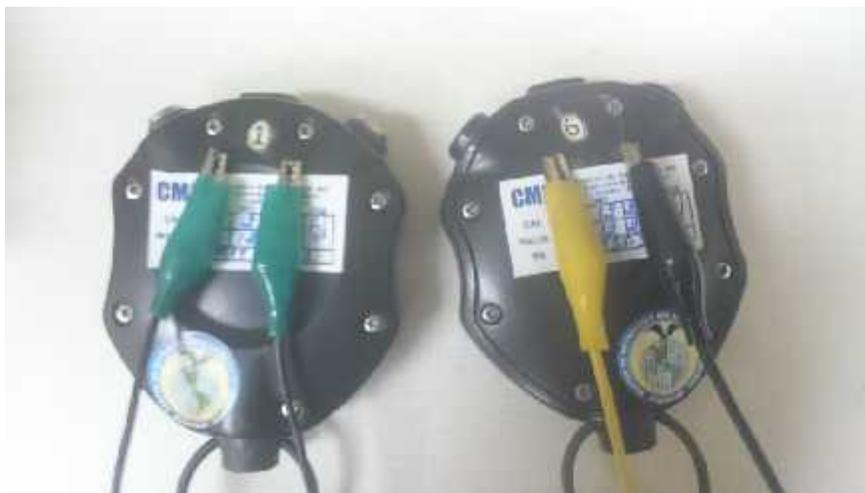
**Figura 58 Conexión de cronómetros en pines de arranque posteriores**
