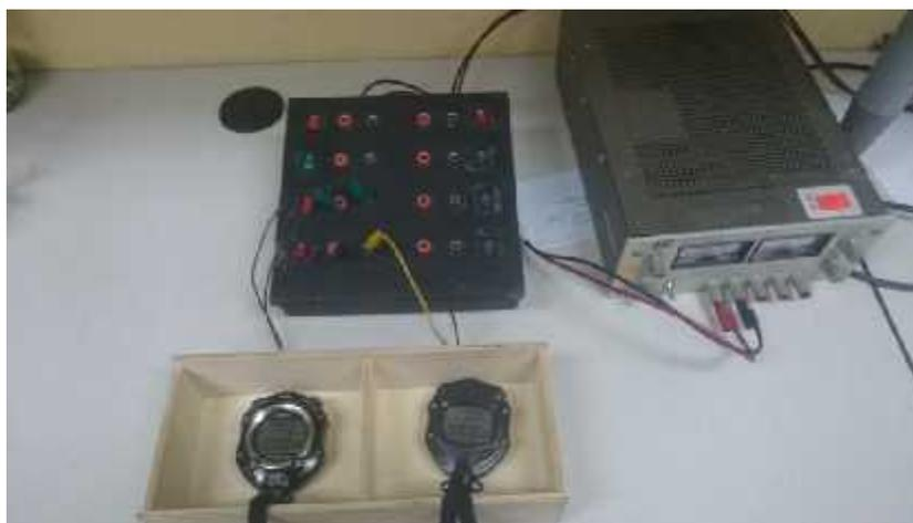
**Figura 59 Cronómetros conectados a fuente de arranque**
