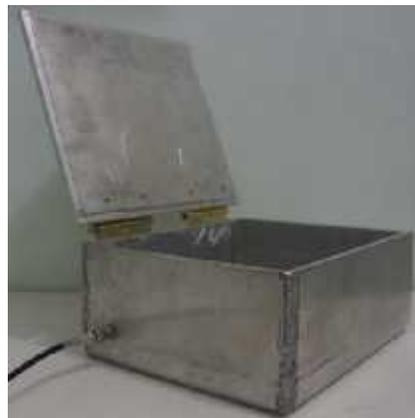
**Figura 50 Prototipo final del blindaje metálico**
