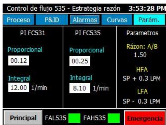
Figura 104. Pantalla de configuración de parámetros del controlador
