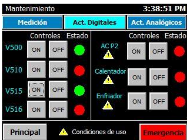
Figura 109. Pantalla de activación de actuadores digitales
