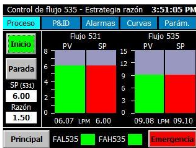
Figura 102. Pantalla de variables de proceso de la estrategia razón de flujos
