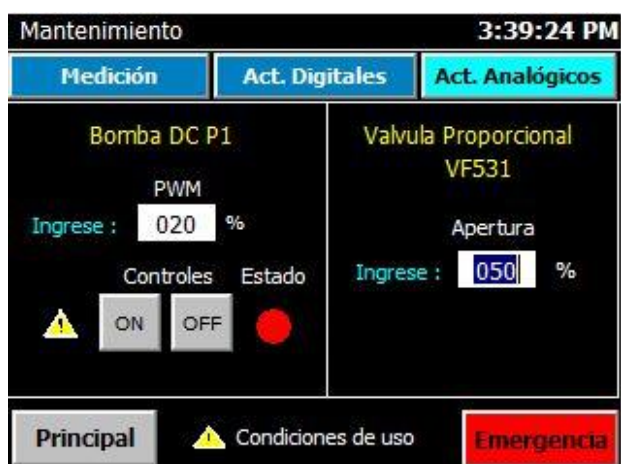
Figura 110. Pantalla de activación de actuadores analógicos
