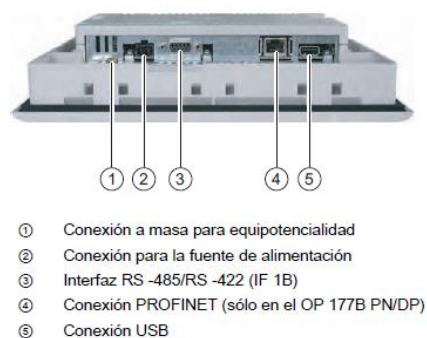
Figura 85. Puertos de conexión del panel OP177B
