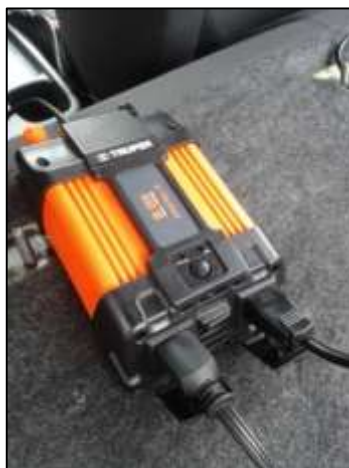
Figura 59 Conexión de inversor de corriente con cable de analizador
