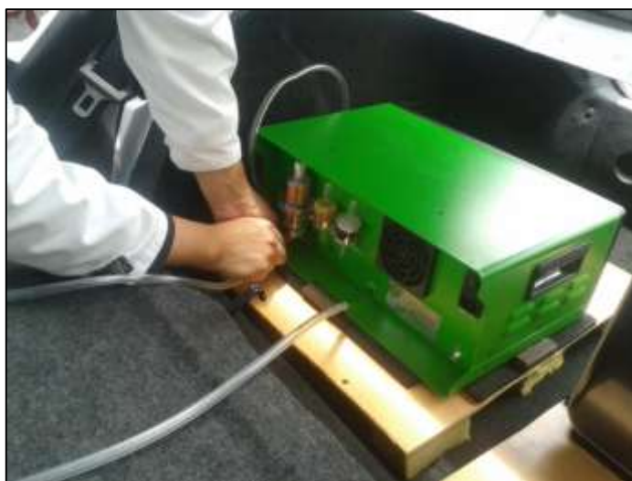
Figura 56 Conexión de mangueras en analizador de gases
