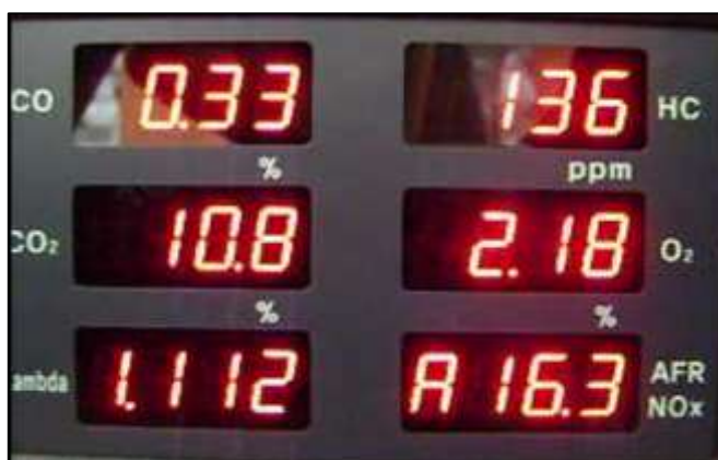
Figura 51 Análisis de gases en progreso
