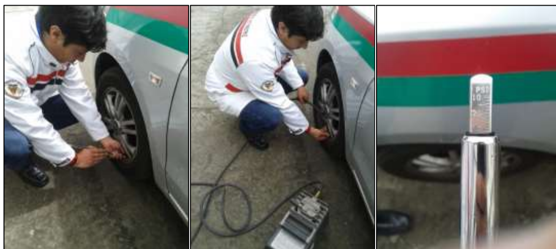
Figura 58 Medición de presión de aire, llenado de aire, Medida de 32 PSI.
