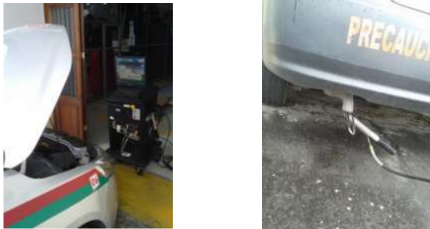
Figura 23 Análisis de gases en prueba estática Chevrolet Sail, Chevrolet Aveo.
