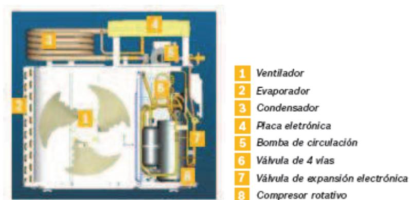
**Figura 18 Principales componentes bomba de calor**
