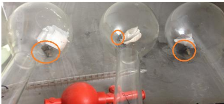
Figura 78. Núcleos de ebullición
