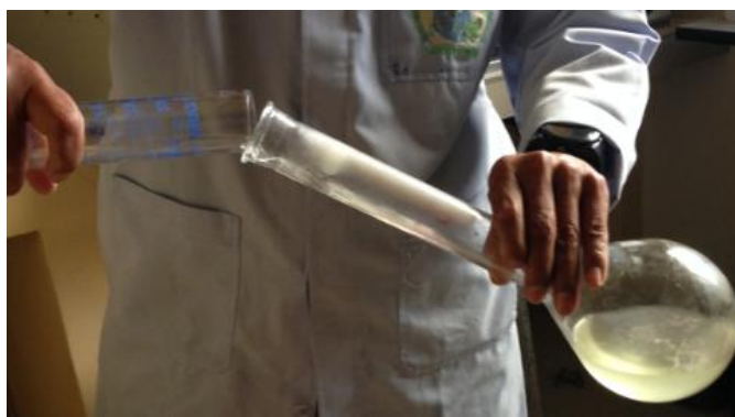
Figura 85. Dilución del contenido del matraz
