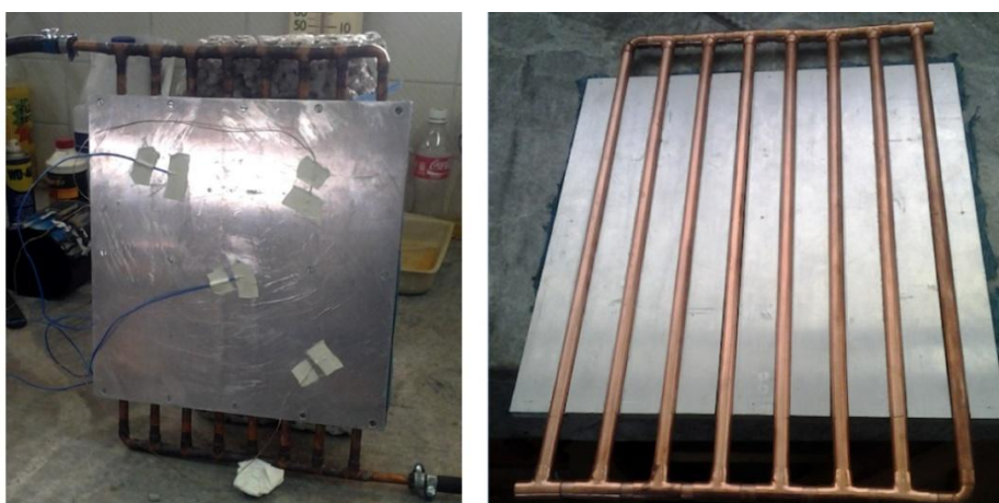
Figura 104. Placa Fría y su sistema de distribución
