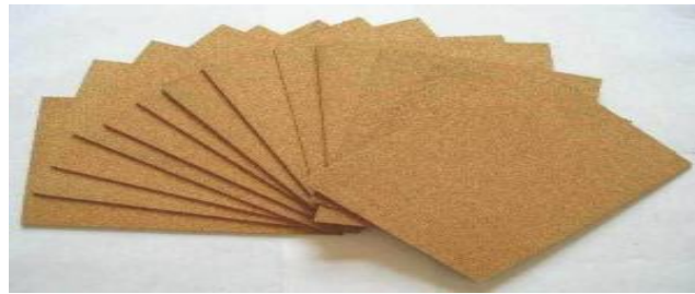
Figura 26. Aislamiento Térmico de Corcho
