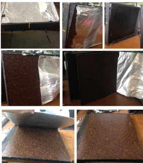
Figura 55. Desmolde del Tablero
