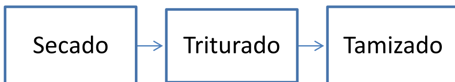
Figura 39. Procesos preliminares a la etapa de Separación
