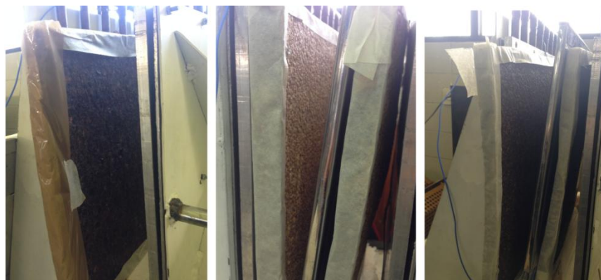
Figura 107. Tableros aglomerados en el aparato de medición
