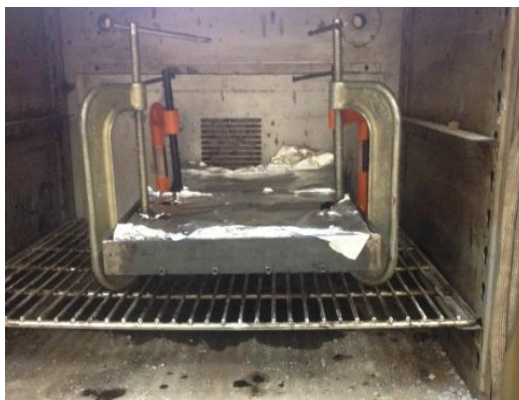
Figura 54. Etapa de Secado del Tablero
