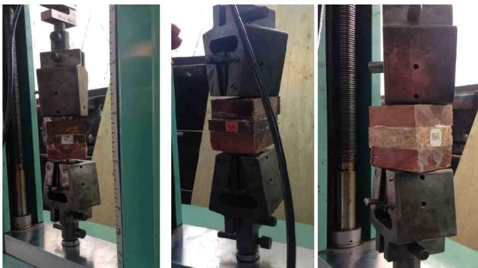
Figura 125. Probetas en la máquina de ensayos universales
