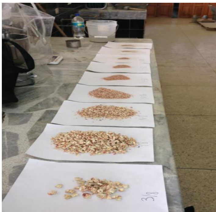
Figura 101. Separación de Partículas de Tusa de Maíz
