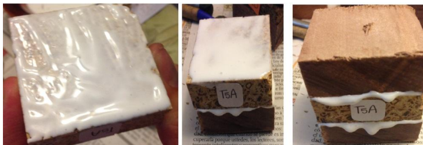
Figura 123. Aplicación de adhesivo
