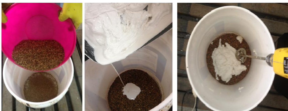
Figura 47. Etapa de Mezclado de la Biomasa con Almidón
