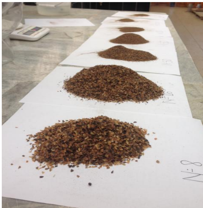
Figura 100. Separación de Partículas de Café
