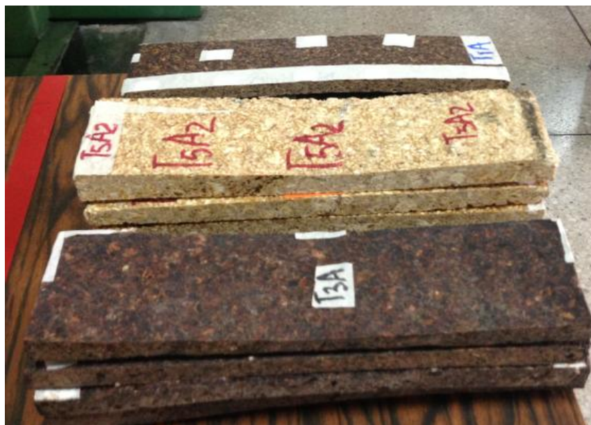
Figura 112. Probetas para ensayo de resistencia a la Flexión
