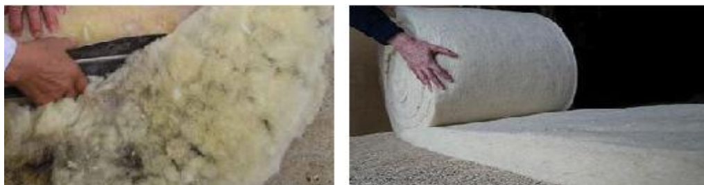
Figura 17. Elaboración de la Lana de Oveja
