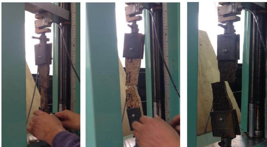
Figura 120. Falla a Tracción Paralela
