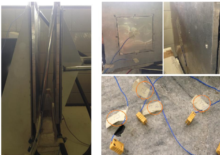
Figura 109. Zonas de medida de temperatura
