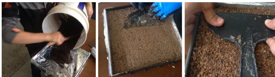
Figura 52. Formación del Tablero
