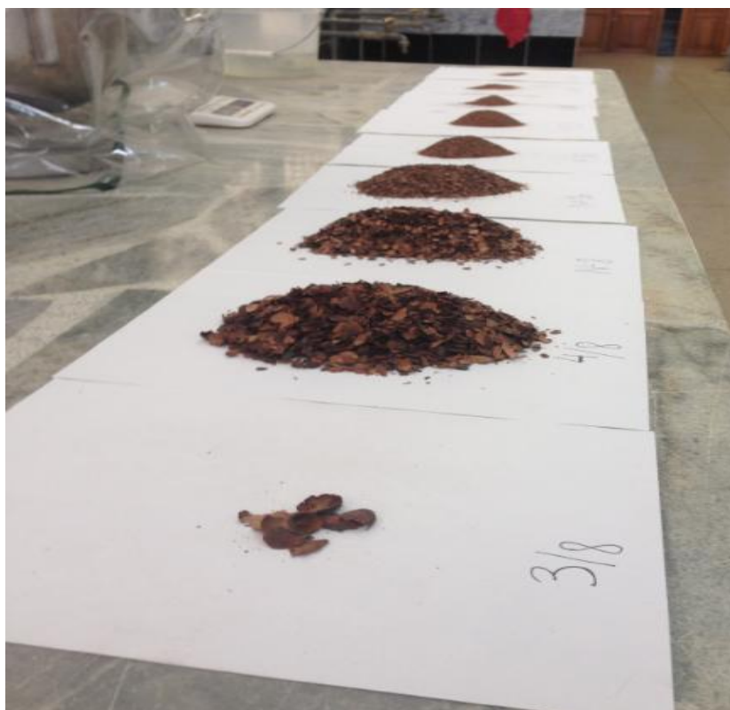
Figura 99. Separación de partículas de Cacao
