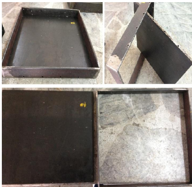
Figura 50. Molde de Acero
