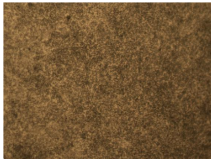
Figura 100: Micrografía Acero AISI 01. Nital 3 %, 15s amplificación 100X. Fuente: [Luis Soriano, 2012].
