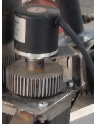
Figura 99 Acople encoder incremental – piñón
