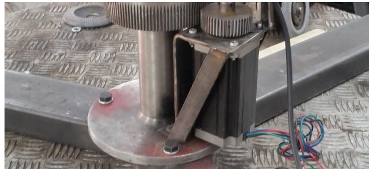
Figura 93 Ensamble del engranaje para el giro de los brazos que transportan las camisetas
