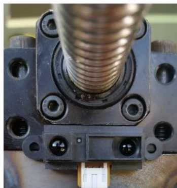
Figura 98 Ubicación del sensor IR GP2Y0A21YK0F
