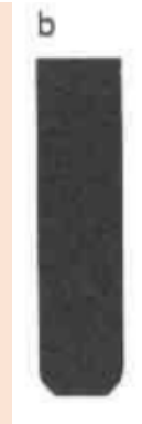
Figura 29 Racle de filo rectangular y cantos romos
