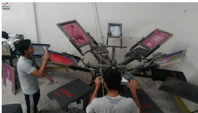
Figura 1 Máquina Serigráfica Manual Textil Tipo Pulpo de la Empresa Ortega de la Barra
