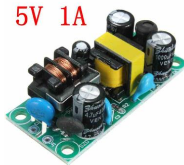
Figura 88 Fuente de voltaje 110 VAC a 5 VDC - 1A
