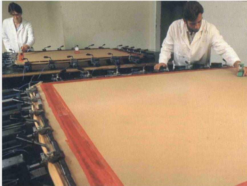
Figura 23 Tensado de marco maestro de serigrafía
