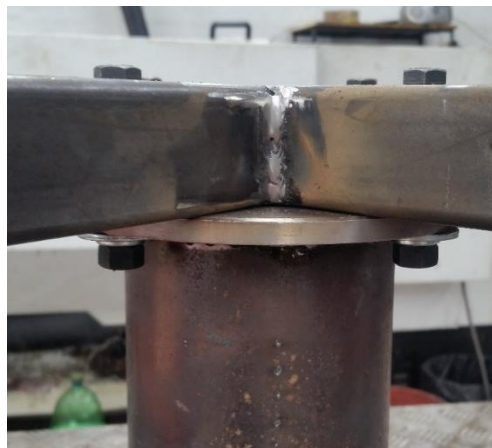
Figura 94 Unión brazos giratorios – eje de engranaje mediante pernos
