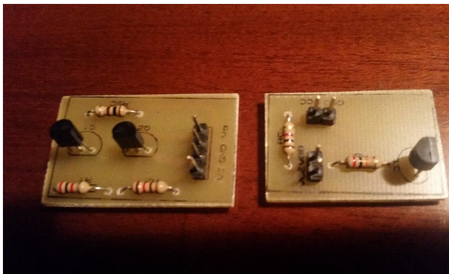
Figura 102 Elaboración de las placas PCB del circuito acondicionador y del circuito protector de contra sobre corrientes
