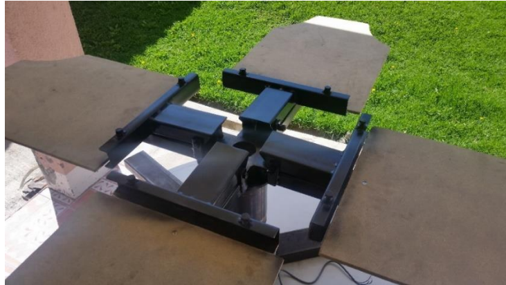
Figura 95 Ensamble final de los brazos giratorios de la máquina
