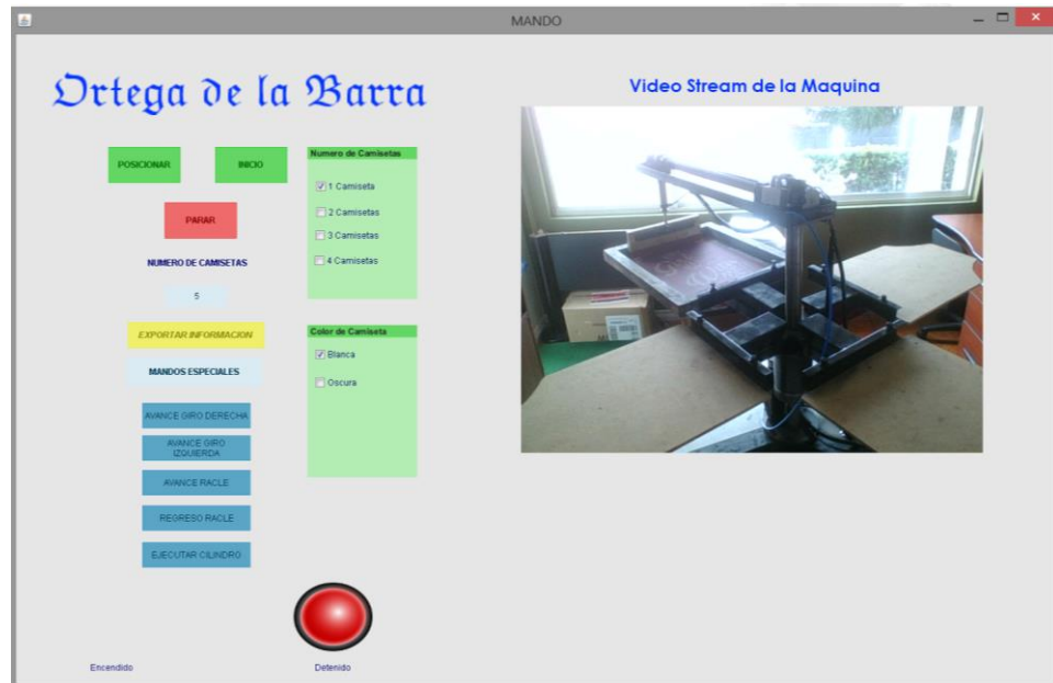
Figura 110 Ventana de mando completa con visualización de video stream de la máquina serigráfica automatizada
