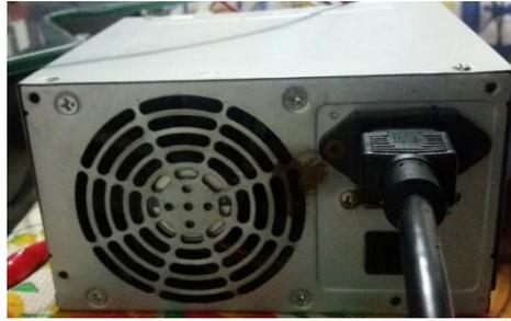
**Figura 42** Fuente de voltaje ATX
