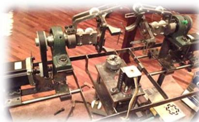
Figura 117 Estructura de máquina bobinadora
