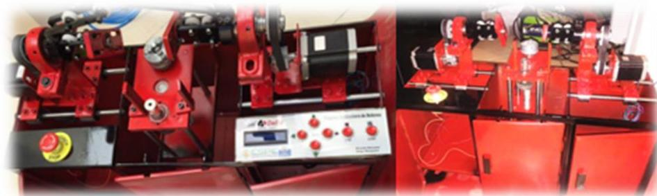
Figura 111 Máquina bobinadora de Rotores
