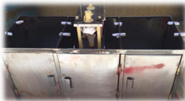
Figura 109 Fabricación de carcasa para MB
