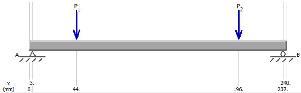
Figura 57 Diagrama de cargas sobre una viga simplemente apoyada
