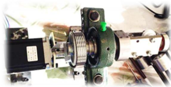
Figura 113 Montaje de poleas y banda dentada
