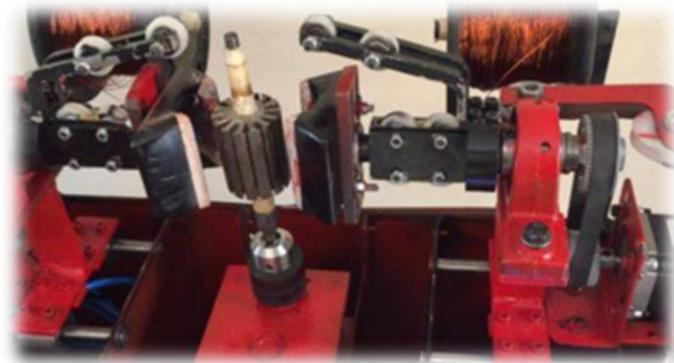
Figura 127 Apertura de mordazas por sistema neumático
