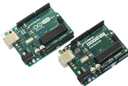
Figura 98 Placa Arduino UNO
