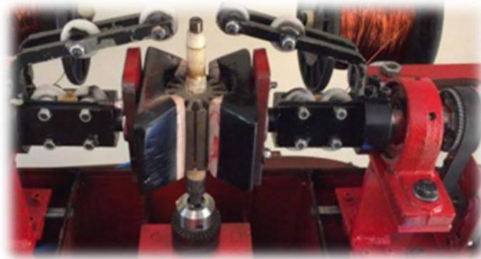
Figura 126 Cierre de mordazas por sistema neumático
