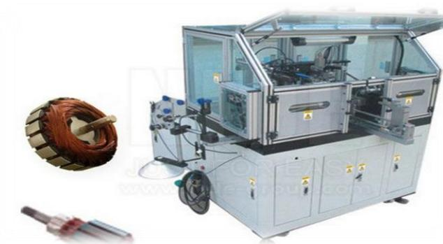
Figura 22 Bobinadora Automática
