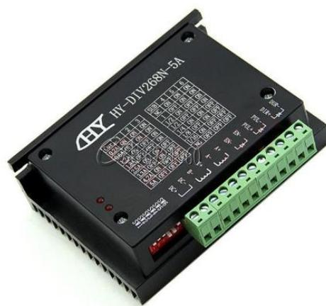
Figura 92 Módulo controlador para motores a pasos
