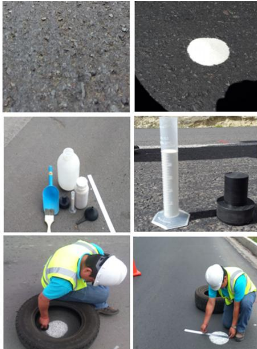
Figura 19. Procesamiento de Ensayo Mancha de Arena
