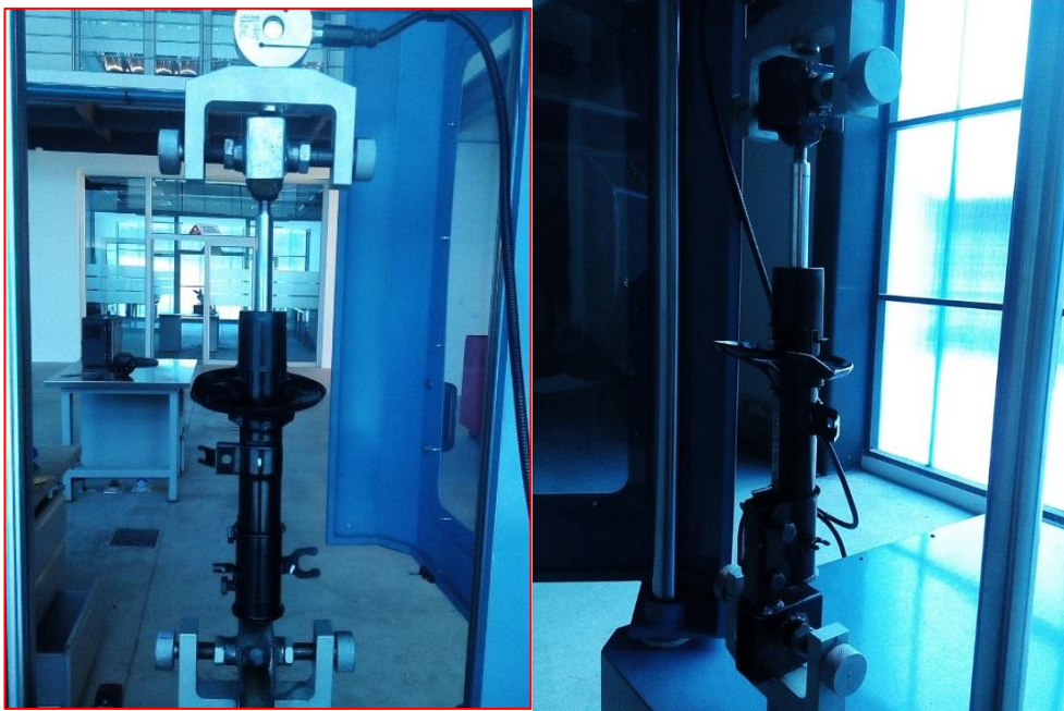
Figura 47 Soportes y amortiguador fijados en el banco
