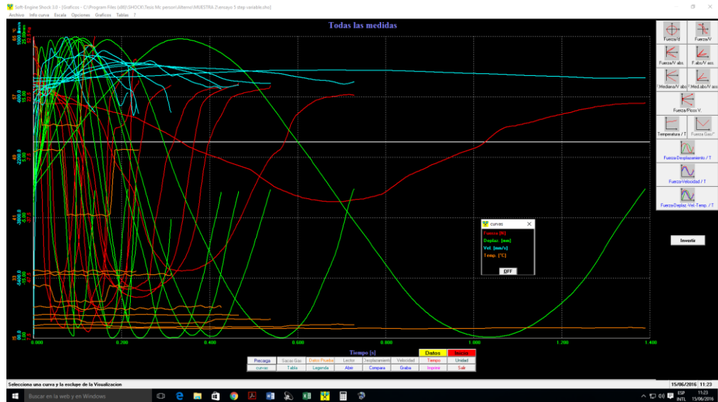
Figura 73 Fuerza, velocidad, desplazamiento y temperatura en función del tiempo, muestra 2; E5.
