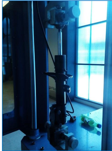
Figura 39 Nivelar el soporte con amortiguador
