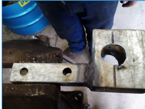
Figura 37 Ensamblado, agujeros y soldadura
