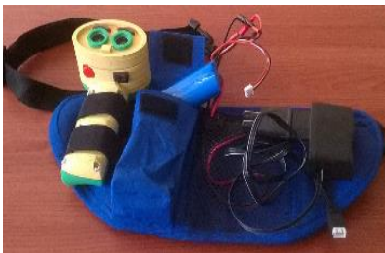
Figura 76 Sistema de detección de obstáculos final.
