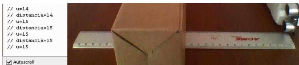
Figura 62 Lectura de 15 cm de distancia, entre objeto y sensor.
