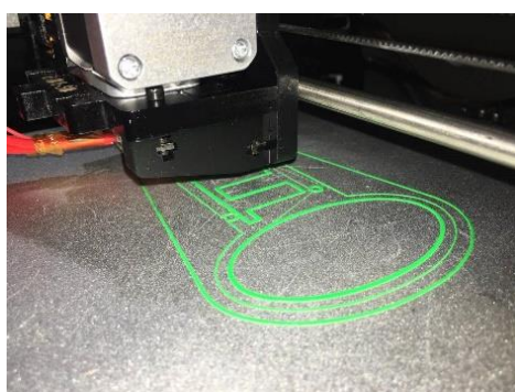
Figura 52 Impresión 3D de la tapa posterior del dispositivo: a) inicio, b) fin.
