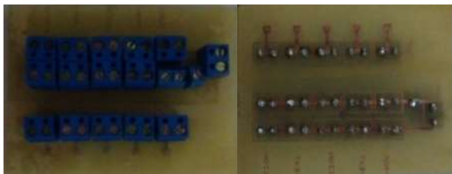
Figura 66. Placa de control finalizada
