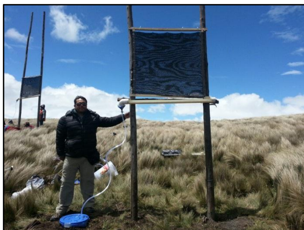
Figura 9. Sistema de Atrapanieblas en la Comunidad de Galte, Chimborazo, Ecuador.
