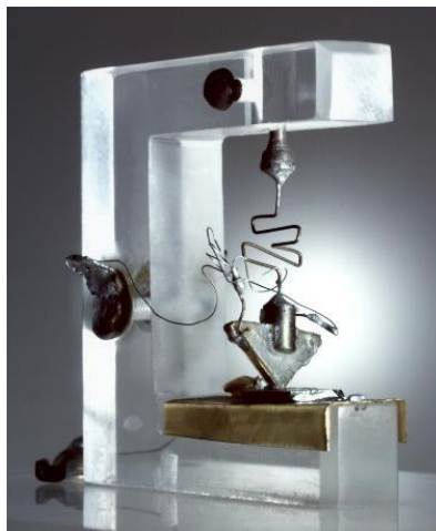
Figura 18. Primer transistor realizado por físicos W. Shockley, J. Bardeen y W. Brattain
