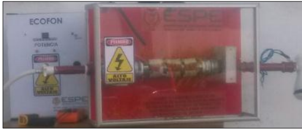
Figura 185 Sistemas Integrados, prototipo de calentamiento de agua por inducción electromagnética
