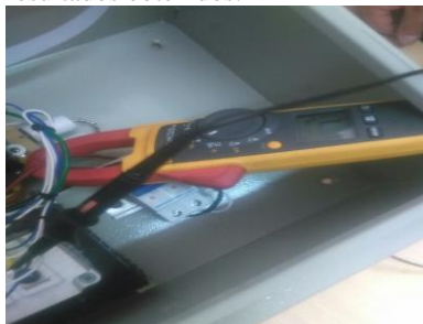
Figura 19 Medición de corriente de entrada prototipo de calentamiento de agua de inducción electromagnética
