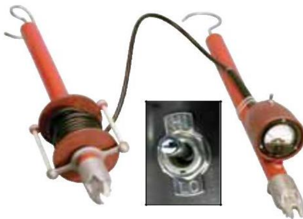
Figura 14. Probadores de fase Fuente: (SYSTEMS, 2011)
