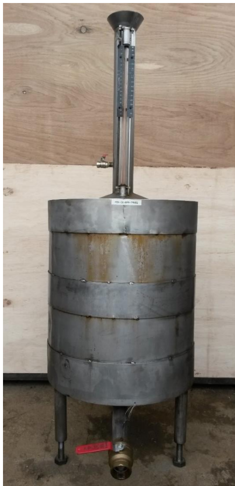
Figura 47: Tanque probador volumétrico
