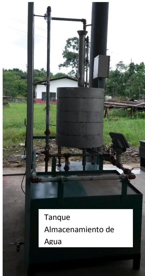
Figura 59: Tanque de almacenamiento de fluido
