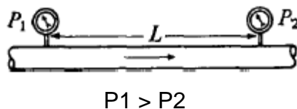
Figura 5: Pérdida de presión en la línea de flujo-ecuación de Darcy
