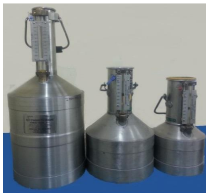
Figura 31: Tamaño de recipientes volumétricos
