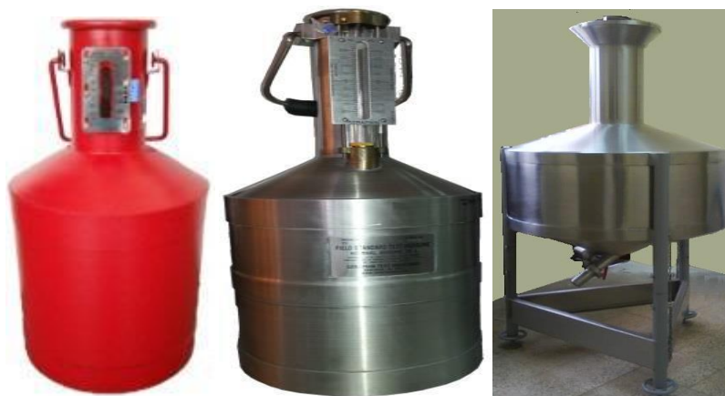
Figura 30: Recipientes volumétricos metálicos tipo Seraphin.
