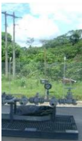
Figura 46: Conexiones al probador para calibración
