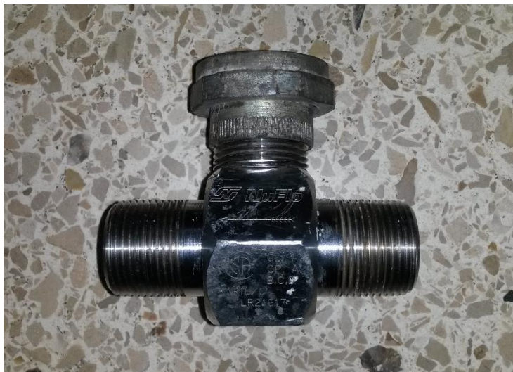
Figura 42: Medidor dinámico de flujo tipo turbina.
