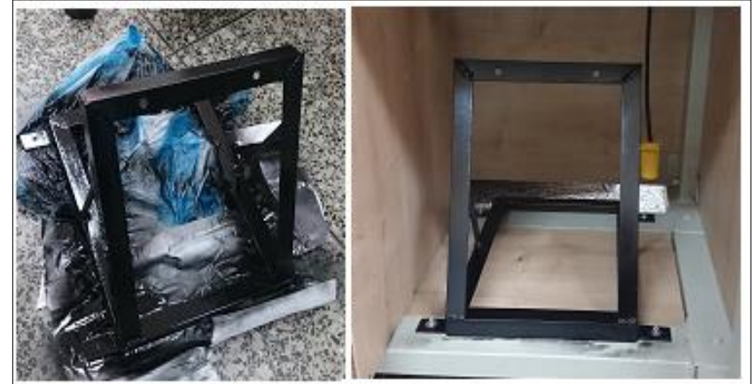
Soporte Bomba hidráulica.
