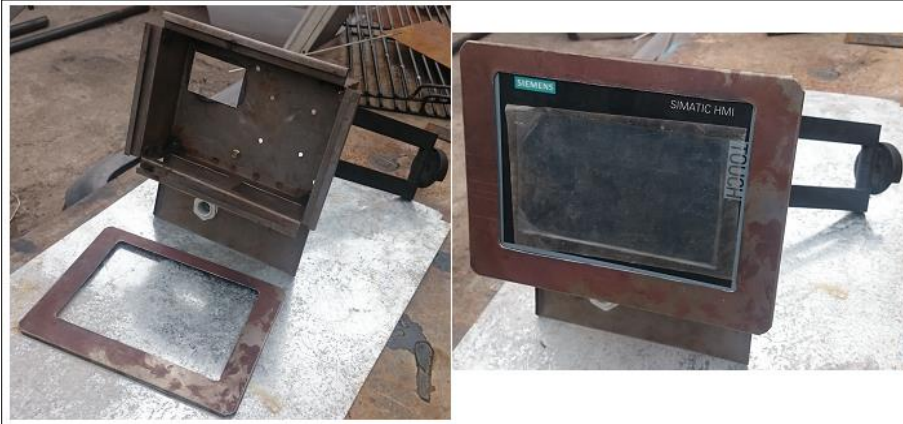
Construcción soporte panel HMI.
