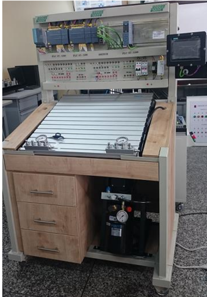
Módulo Profinet terminado
