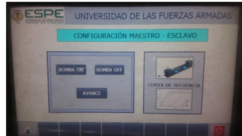
HMI cargado en pantalla SIEMENS
