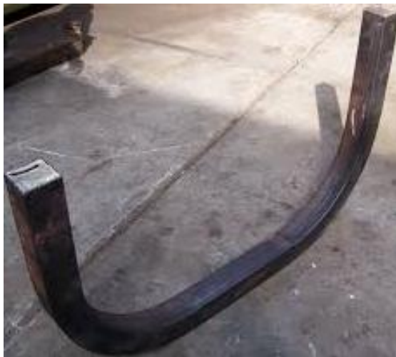
Figura 9 Curvatura en tubo cuadrado.
