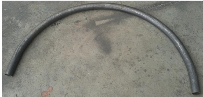
Figura 95 Imprecisión del barolado
