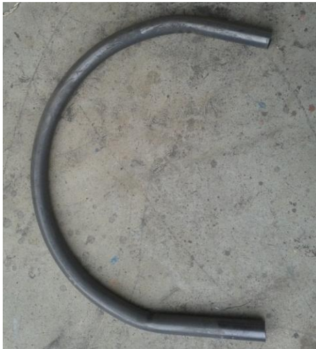
Figura 93 Tubo barolado con asimetría
