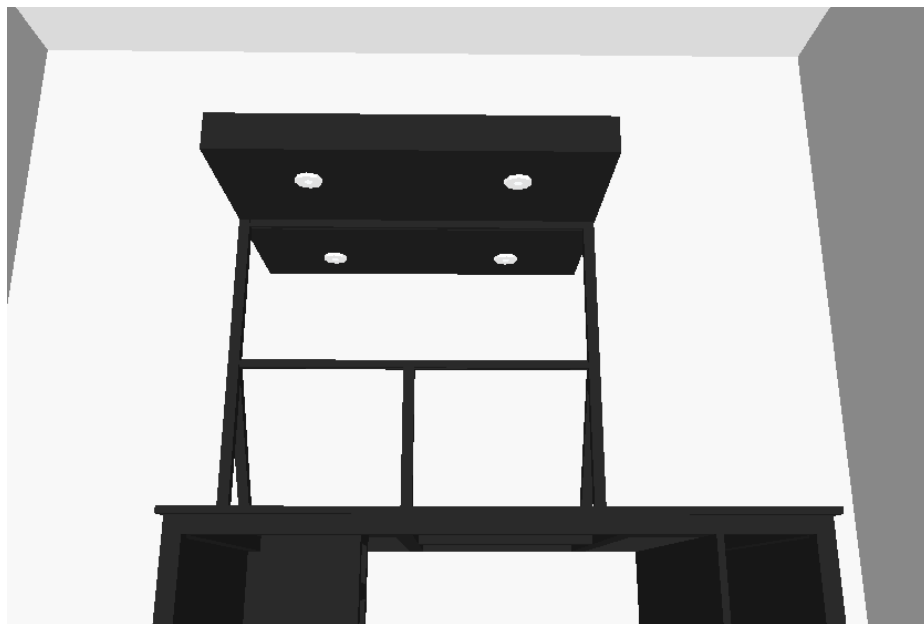
Figura 51 Distribución de luminarias en DIALux vista 3D
