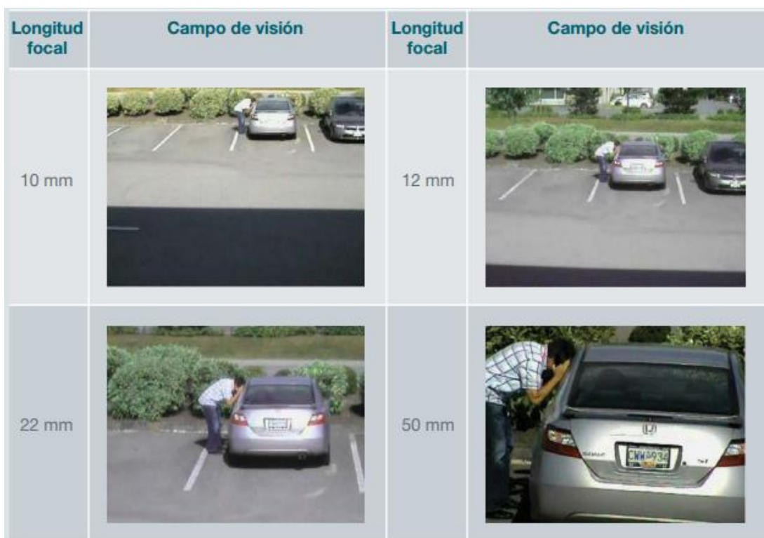
Figura 10 Relación Longitud focal _Campo de visión
