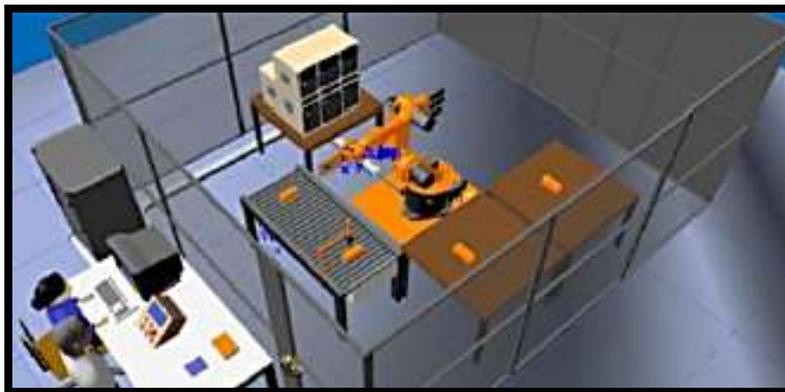
**Figura 1 Celda de manufactura configuración anillo**
