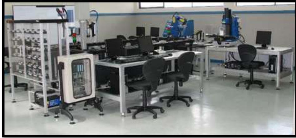
**Figura 80 Celda de manufactura instalada en la Universidad San Francisco de Quito**
