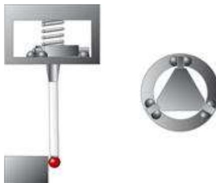
**Figura 14 Componentes de una sonda (Muelle)**
