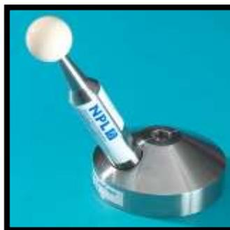
**Figura 63 Esfera de prueba de aceptación del sistema de palpación**
