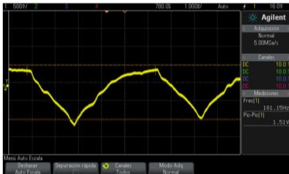
**Figura 61 Señal de Accionamiento de la Sonda de Medición**
