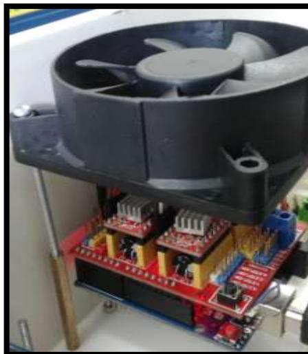
**Figura 48 Bloque de ubicación del Arduino Uno Rev 3.0, CNC Shield, Driver A4988 y Ventilador**
