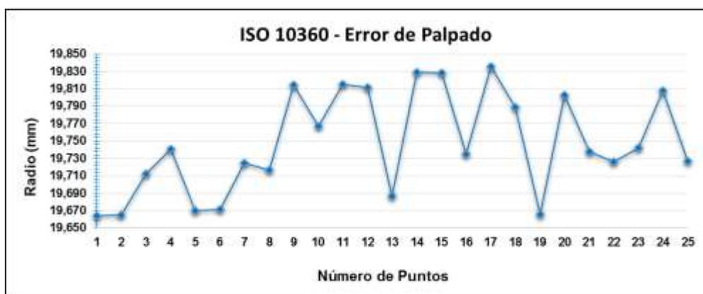
**Figura 66 Variación del error de palpado**
