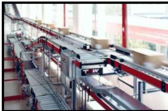
**Figura 8 Transportador de rodillos para el transporte de cartón en la industria del vestido**
