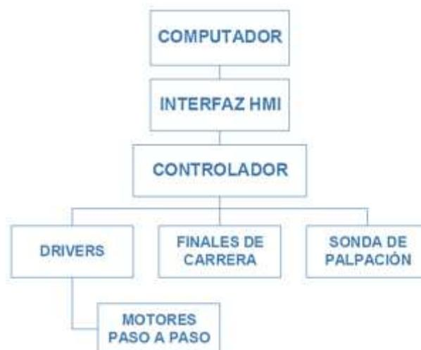
**Figura 25 Arquitectura global del sistema eléctrico**
