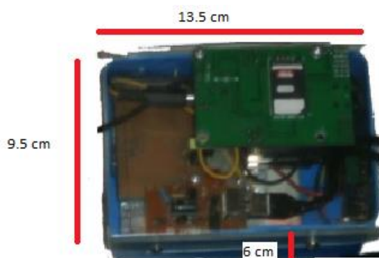
Figura 110 Medidas de la caja contenedora de los componentes de hardware
