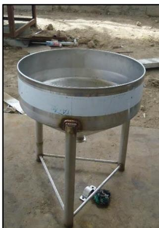
Figura 42. Diseño real del depósito de ANFO
