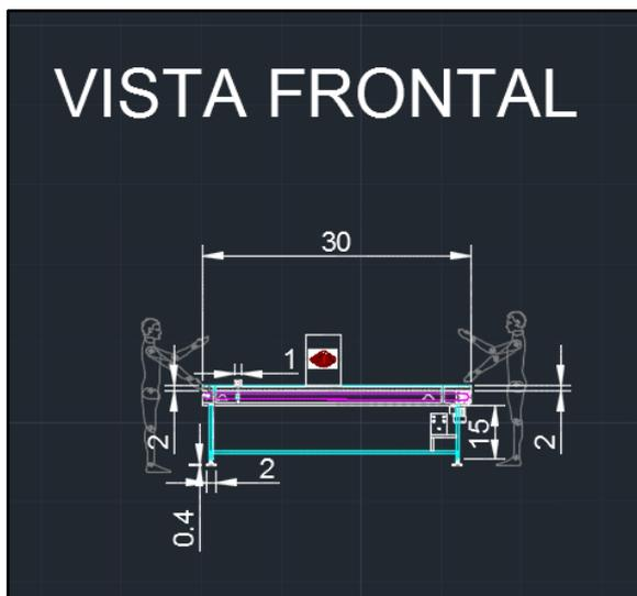
**Figura 61. Diseño del transporte del explosivo ANFO**
