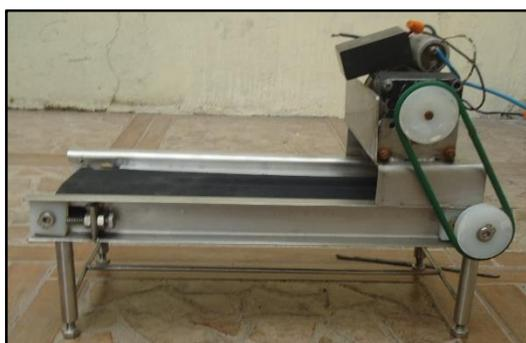
**Figura 62. Banda transportadora real**
