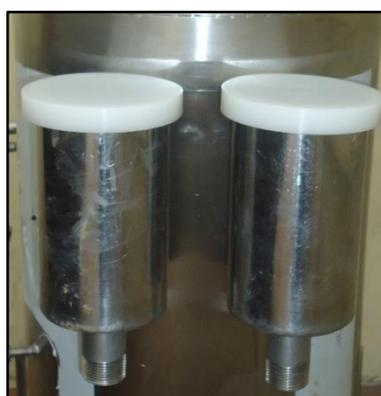
Figura 47. Diseño real del depósito de diésel y emulsión
