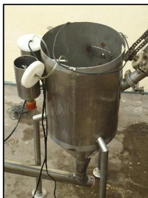
**Figura 57. Diseño real del silo de mezclado**
