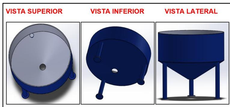
Figura 41. Diseño del depósito de ANFO en SolidWorks.
