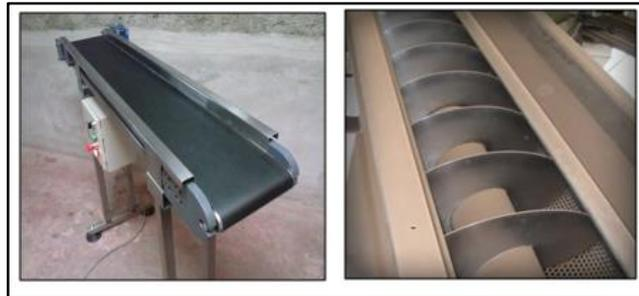
**Figura 66. Banda transportadora Vs tornillo sin fin**
