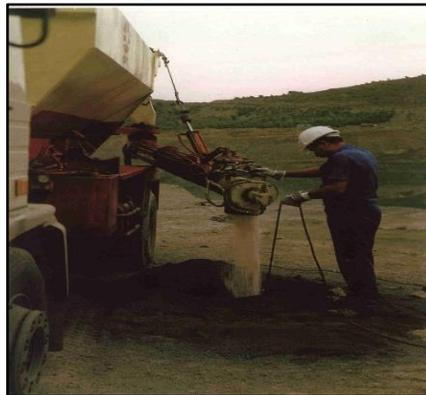
**Figura 2. Camión de carga de ANFO**
