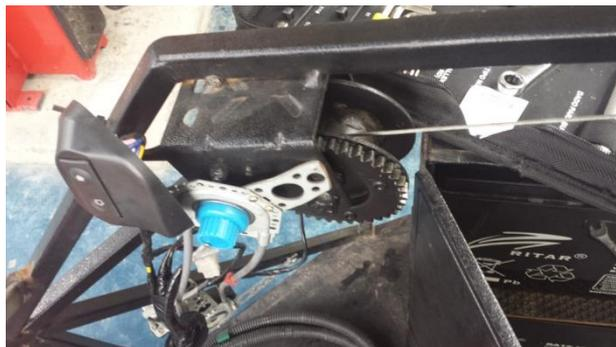
**Figura 178 Motor eléctrico y conjunto de piñones tipo wincha**
