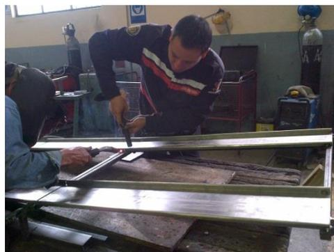
**Figura 159 Unión de partes con soldadura GMAW – MIG**
