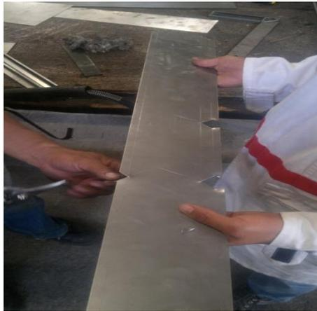
**Figura 158 Construcción de la superficie de la rampa**
