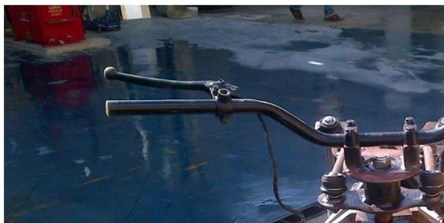
**Figura 180 Ensamble del manillar del freno delantero**
