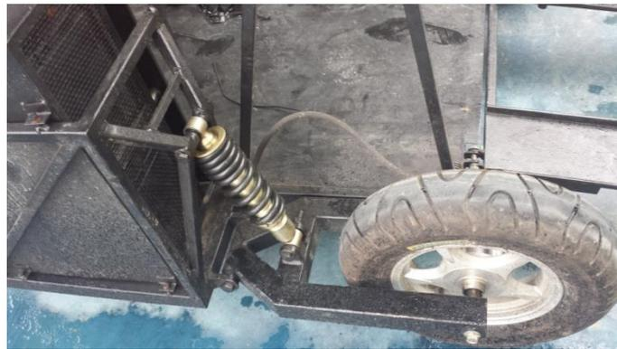
**Figura 185 Ensamble de suspensión trasera**
