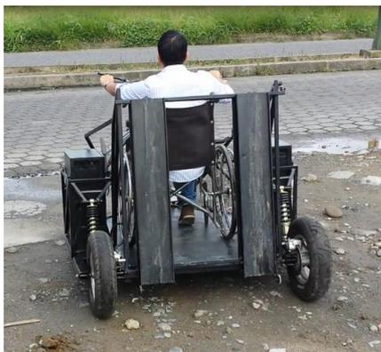
**Figura 191 Dinámica de prueba para el sistema de suspensión**
