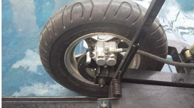
**Figura 182 Ensamble de las mordazas del freno posterior**
