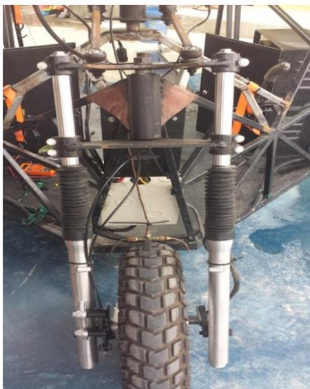
**Figura 184 Ensamble de la suspensión delantera**
