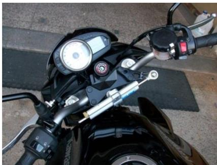
**Figura 69 Amortiguador de dirección**
