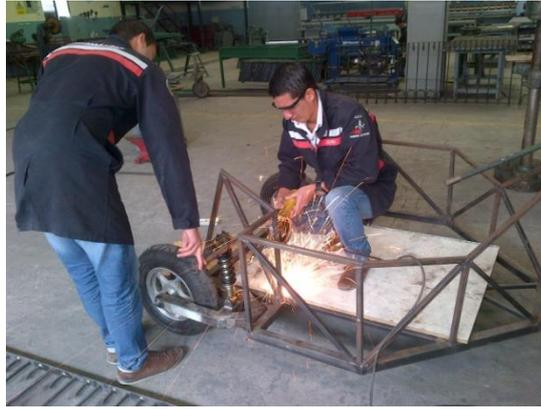
**Figura 167 Construcción de acoples de mesa de suspensión**
