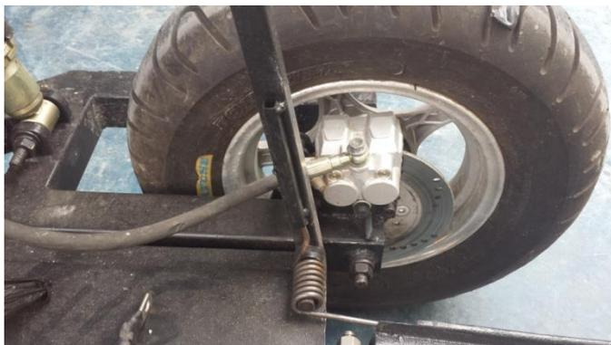
**Figura 176 Ensamble de los resortes de torsión**
