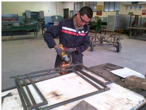
**Figura 156 Construcción de la base de la rampa**
