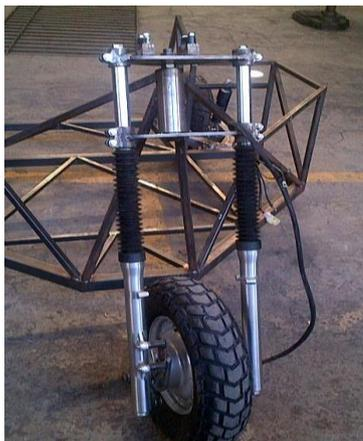
**Figura 186** Ensamble de los árboles de dirección y el eje de dirección de horquilla
