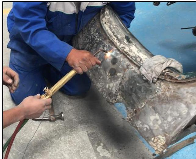
**Figura 75 Enderezada con uso de suelda oxiacetilénica**
