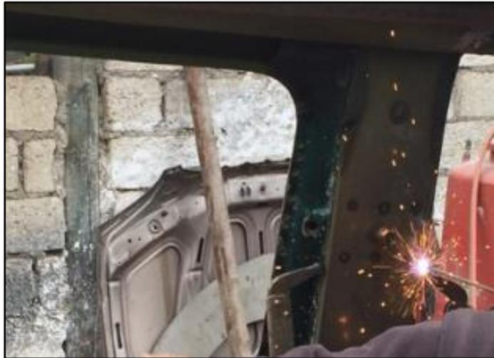
**Figura 69 Unión de carrocería mediante el uso de suelda eléctrica**
