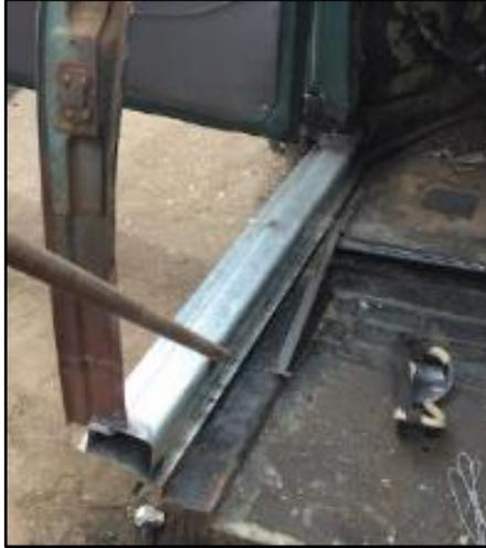
**Figura 78 Alargue del bastidor**
