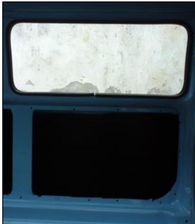
**Figura 86** Modificación del marco para el vidrio parte lateral trasera
