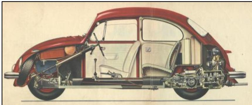
**Figura 6 Vista en corte VW Escarabajo**
