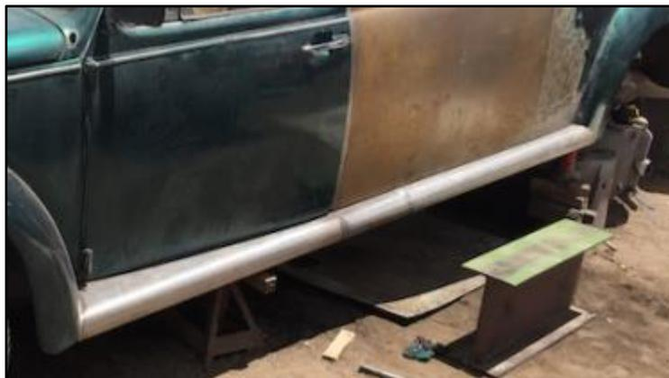
**Figura 88 Construcción de estribos**
