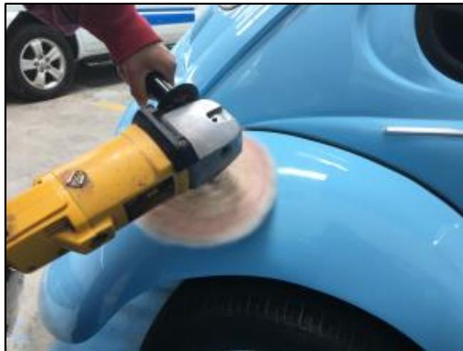
**Figura 108** Proceso de pulido con pulidora
