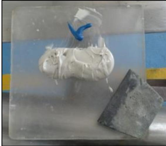
**Figura 94 Acrílico, masilla y caucho para enmasillar**
