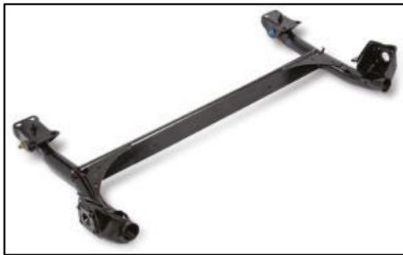
**Figura 10 Constitución del bastidor**
