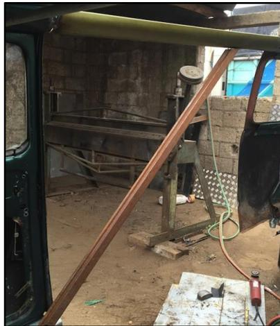
Figura 72 Diagonales en carrocería
