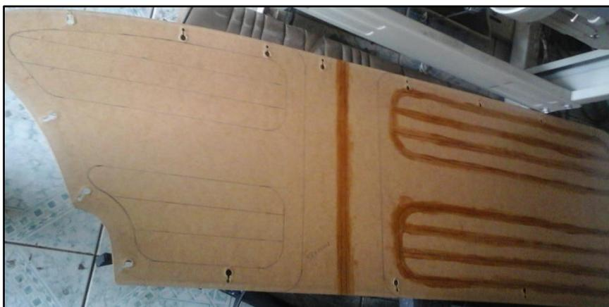
**Figura 113 Molde parte lateral**
