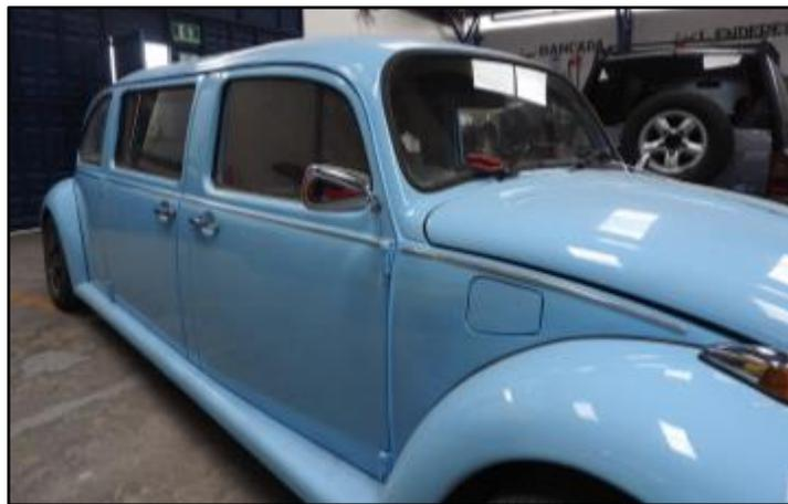
**Figura 91 Carrocería final de limusina Escarabajo**
