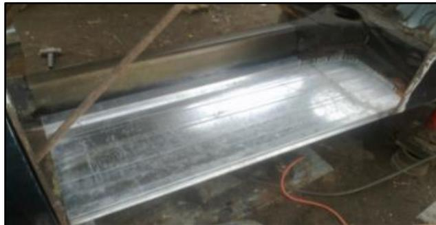
**Figura 79 Cambio de piso de la carrocería**
