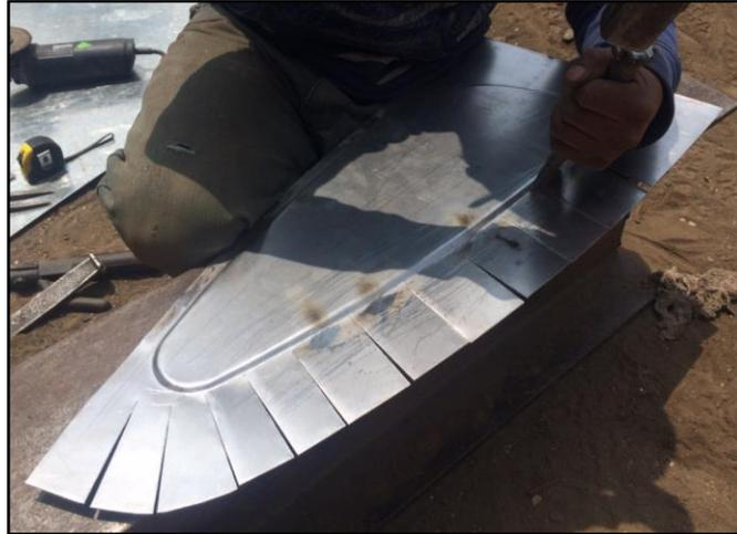
**Figura 89 Moldeo de tol para elaboración parte delantera**
