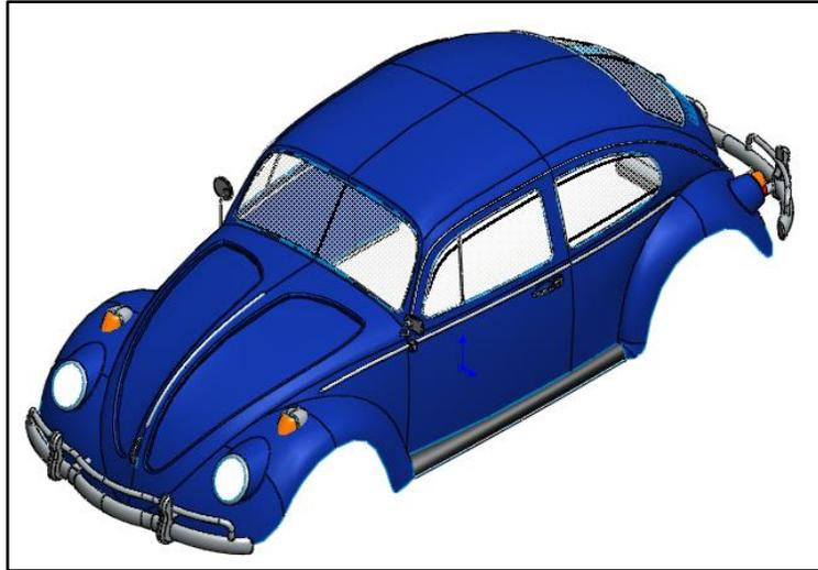
**Figura 25 Modelado carrocería original VW Escarabajo CAD 3D**
