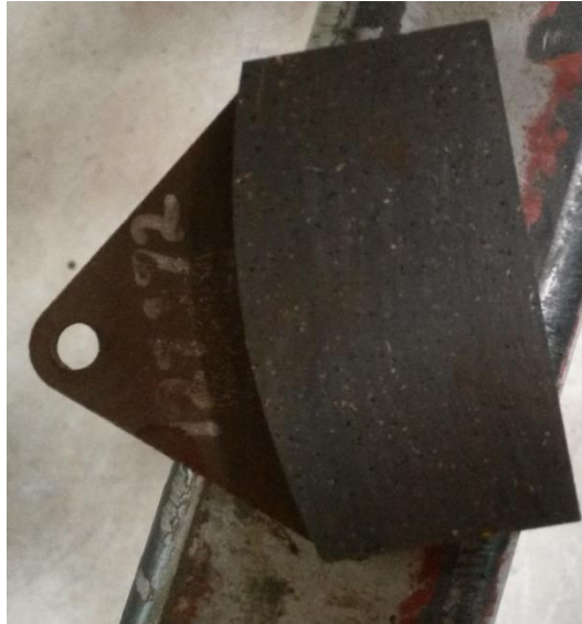
Figura 105 Revisión del estado de pastillas de frenos de Controlador de Tensiones
