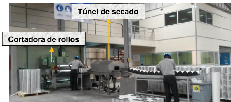
Figura 18 Línea de corte de láminas impermeabilizantes.
