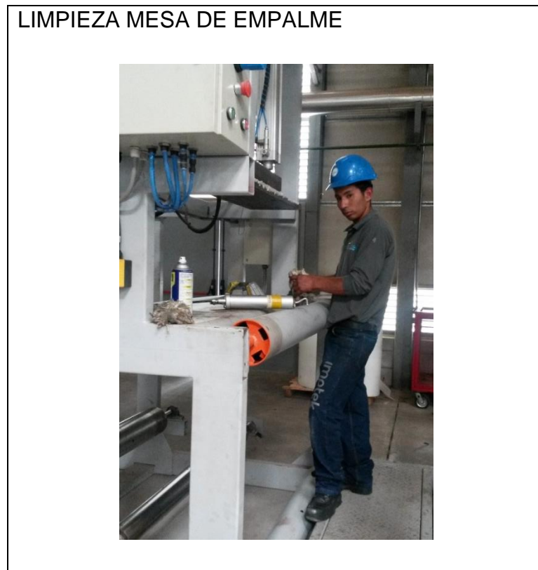
Figura 100 Actividad de Mantenimiento Autónomo. Limpieza mesa de empalme
