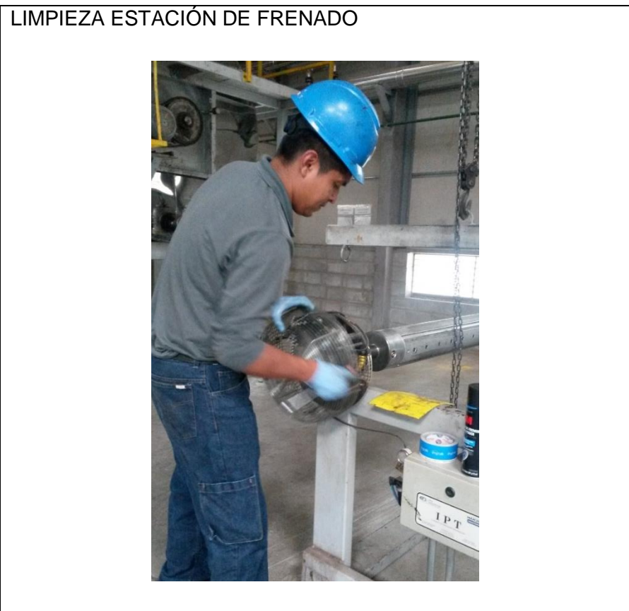
Figura 98 Actividad de Mantenimiento Autónomo. Limpieza estación de frenado
