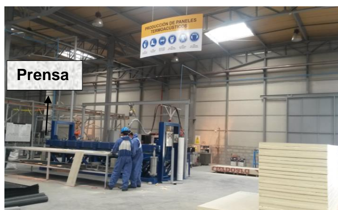
Figura 12 Línea de paneles de poliuretano
