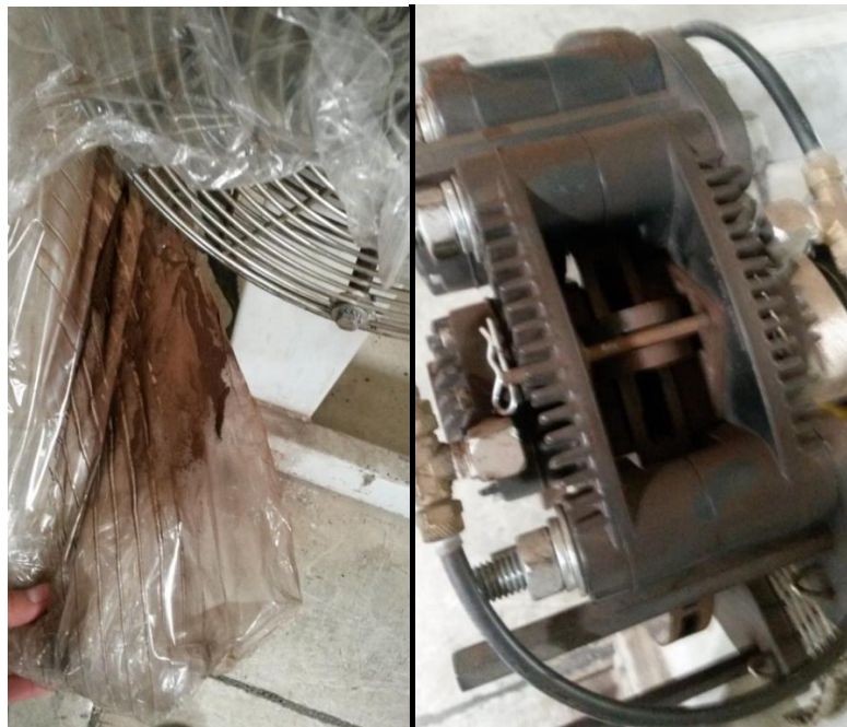
Figura 108 Contaminación de los frenos
