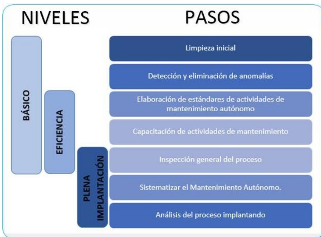
Figura 25 Niveles y pasos del Mantenimiento Autónomo
