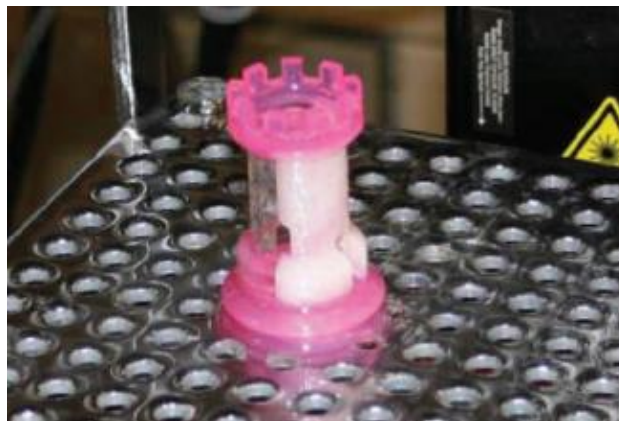
Figura 43: Torre de ajedrez fabricada de varios materiales con la tecnología de estereografía.
