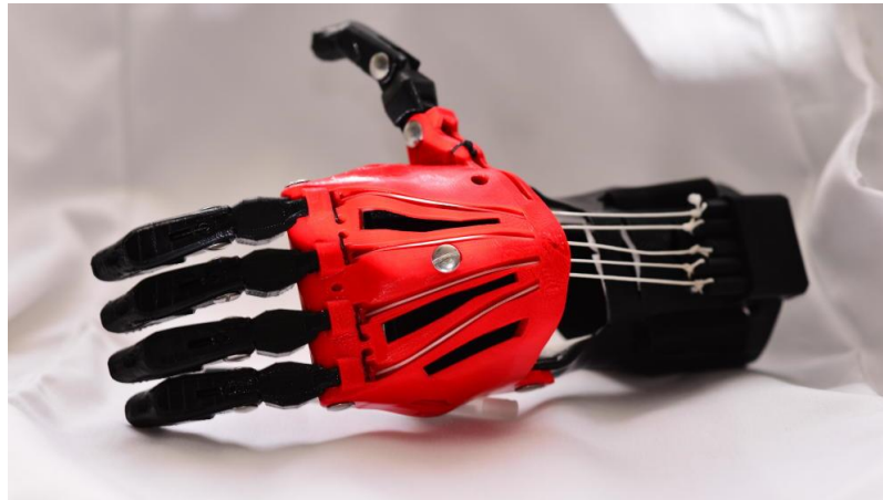
Figura 44: Prótesis de mano, compuesto de varias piezas impresas en 3D.
